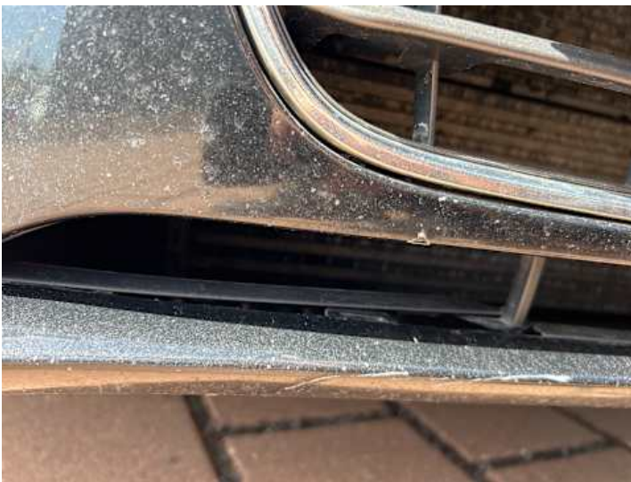
Stoßstange vorne (Kratzer, Verformung, Riss/Bruch)
