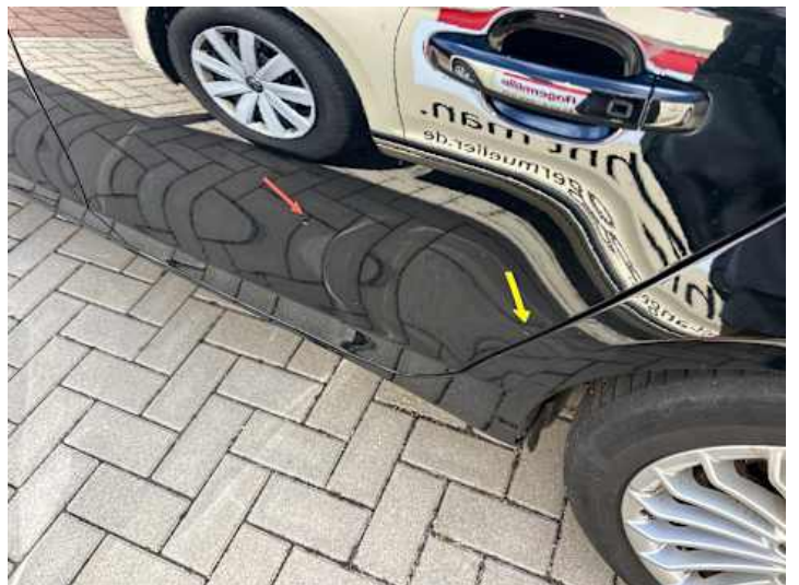
Türe hinten links (Rost, Kratzer)
