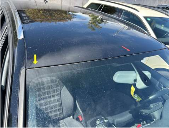
Dach (Steinschlag, Rost)
