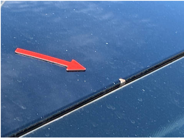
Dach (Steinschlag, Rost)
