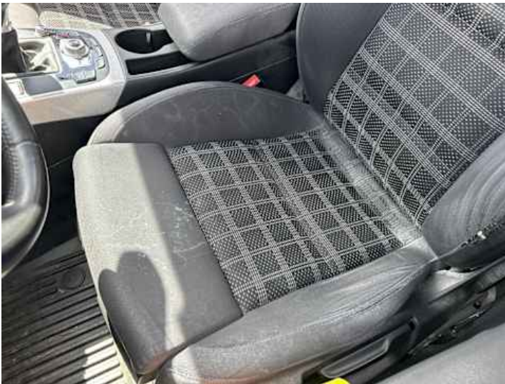
Innenraum (Verschmutzung, Verschleiß, Riss/Bruch)
