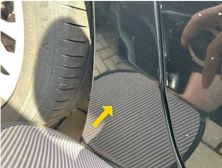
Seitenteil hinten rechts (Rost)
