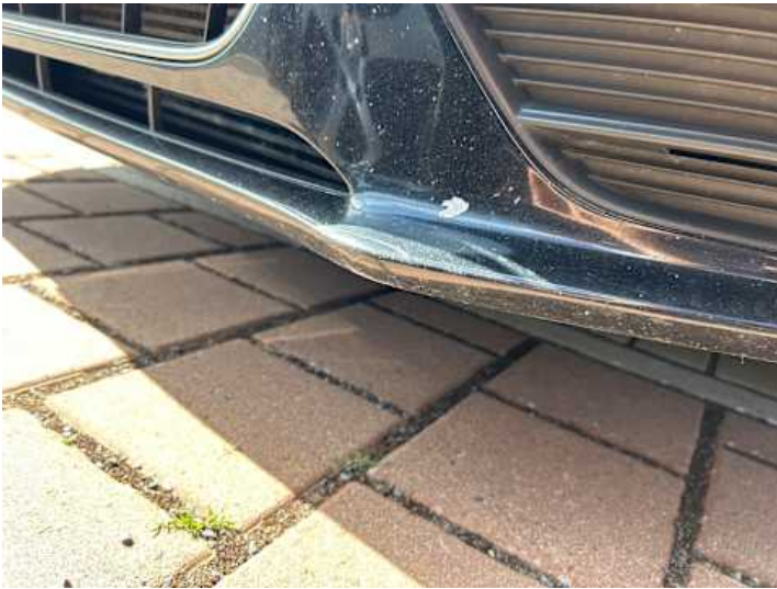
Stoßstange vorne (Kratzer, Verformung)
