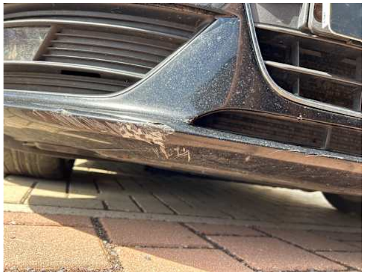
Stoßstange vorne (Kratzer, Verformung, Riss/Bruch)
