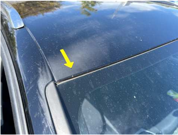
Dach (Steinschlag, Rost)
