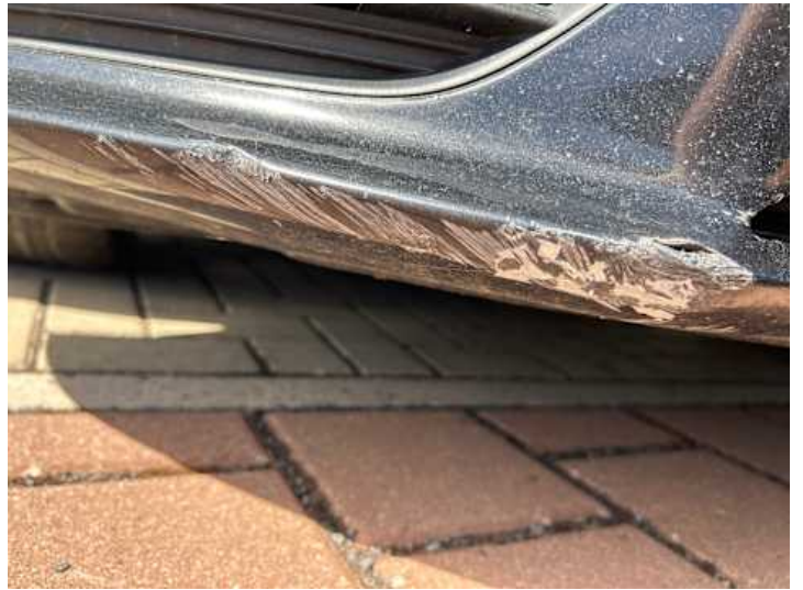
Stoßstange vorne (Kratzer, Verformung, Riss/Bruch)
