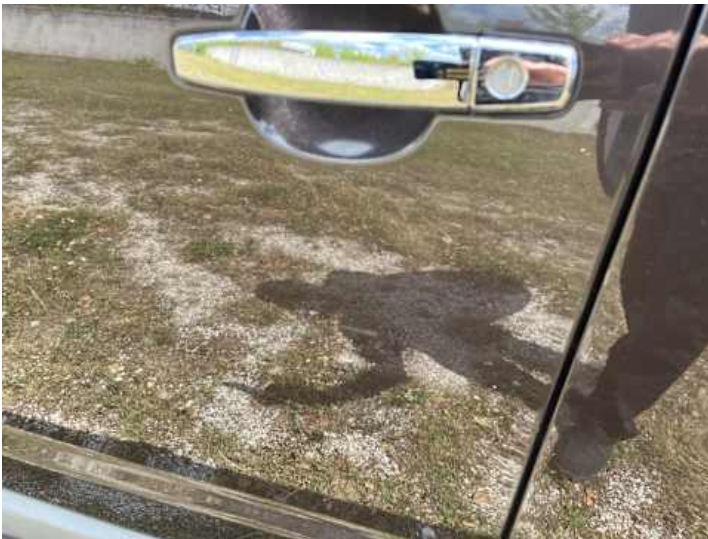
Fahrtür (Delle, Kratzer)
