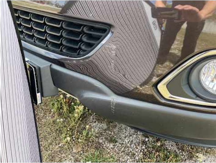
Stoßstange vorne (Delle, Kratzer)
