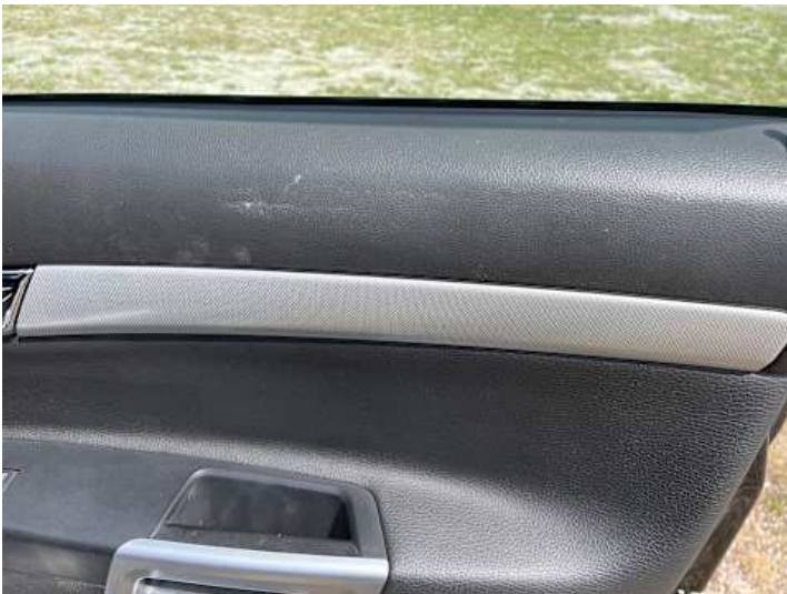
Innenraum (Verschmutzung, Verschleiß)
