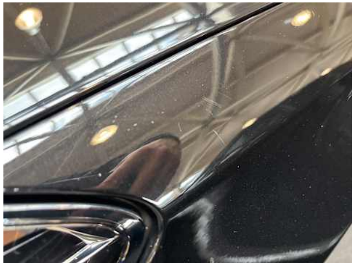
Kotflügel vorne links (Kratzer)
