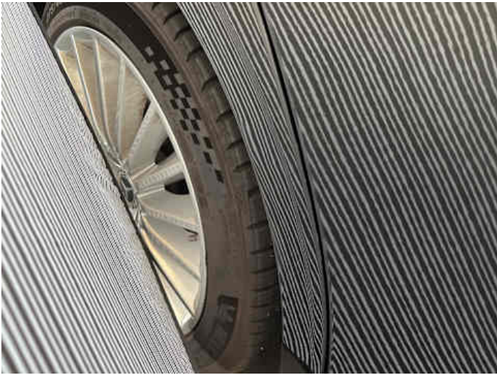
Seitenteil hinten rechts (Delle)
