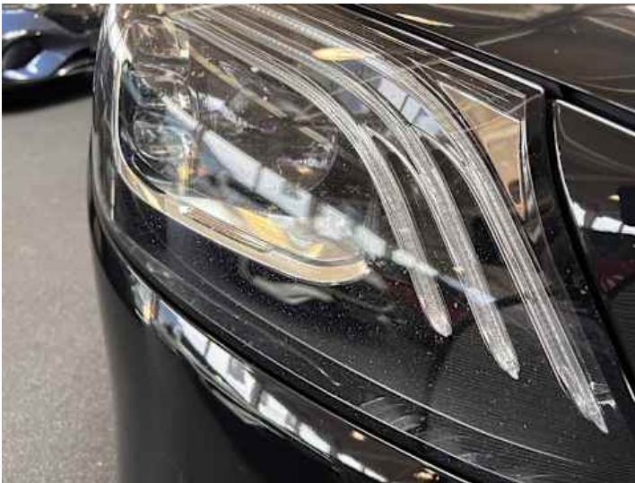
Scheinwerfer (rechts) (Steinschlag)
