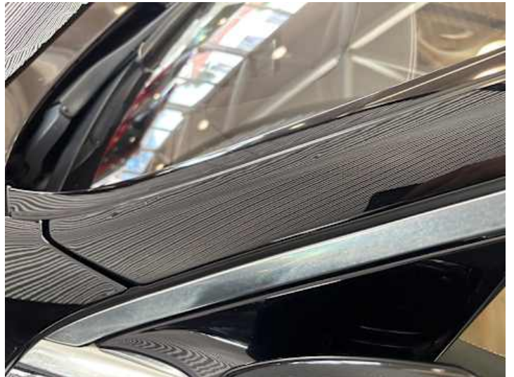
Seitenteil hinten links (Delle)
