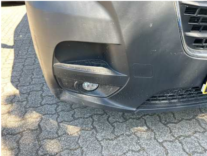
Stoßstange vorne (Verformung, Kratzer)
