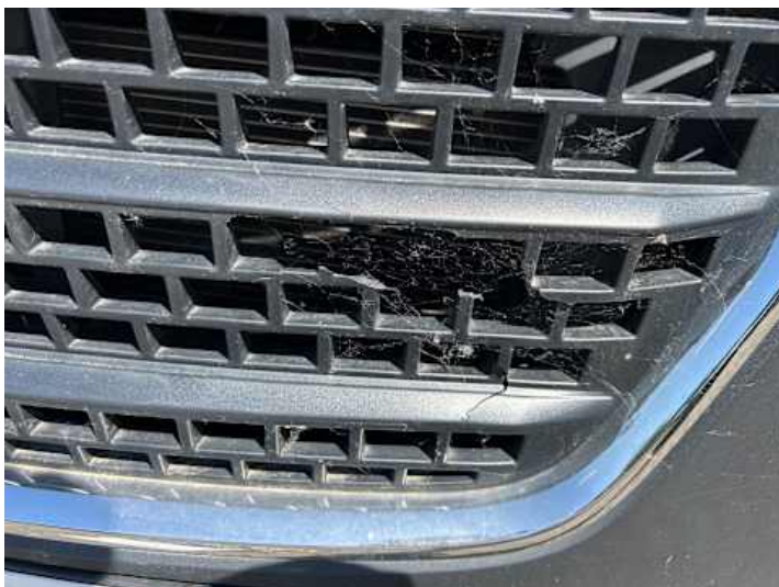
Stoßstange vorne (Riss/Bruch)
