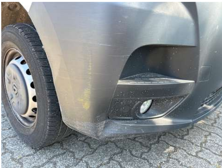
Stoßstange vorne (Verformung, Kratzer)
