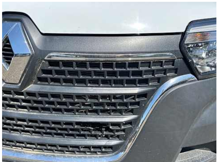
Stoßstange vorne (Riss/Bruch)
