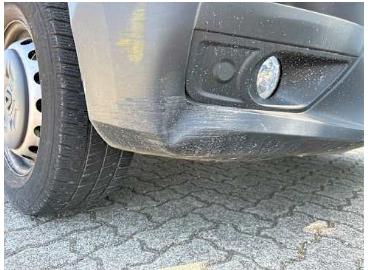
Stoßstange vorne (Verformung, Kratzer)
