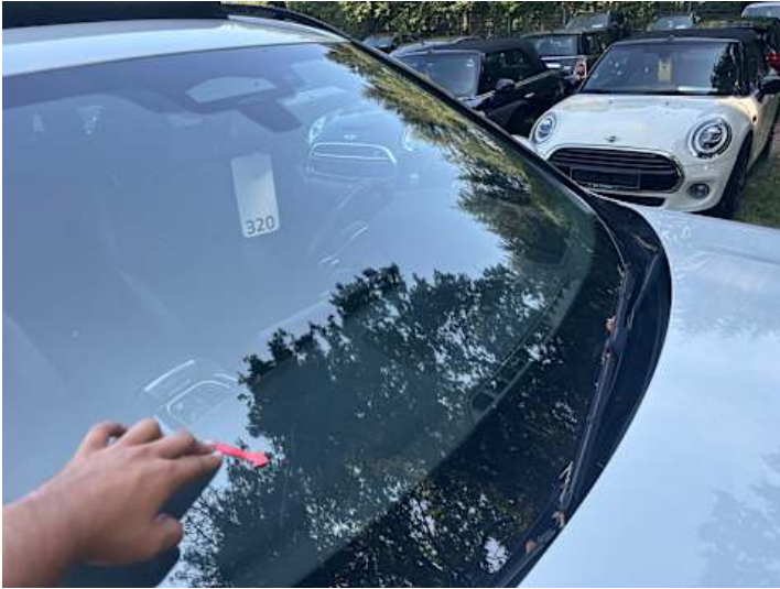
Windschutzscheibe (Steinschlag, Riss/Bruch)
