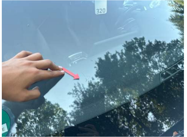
Windschutzscheibe (Steinschlag, Riss/Bruch)
