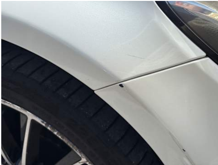
Kotflügel vorne rechts (Kratzer, Lackschaden)
