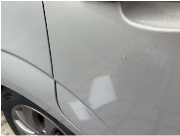
Türe hinten rechts (Kratzer)
