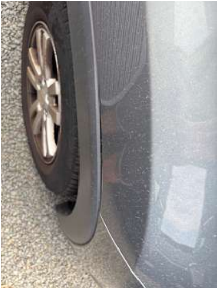
Kotflügel vorne rechts (Spaltmaße ungenau)
