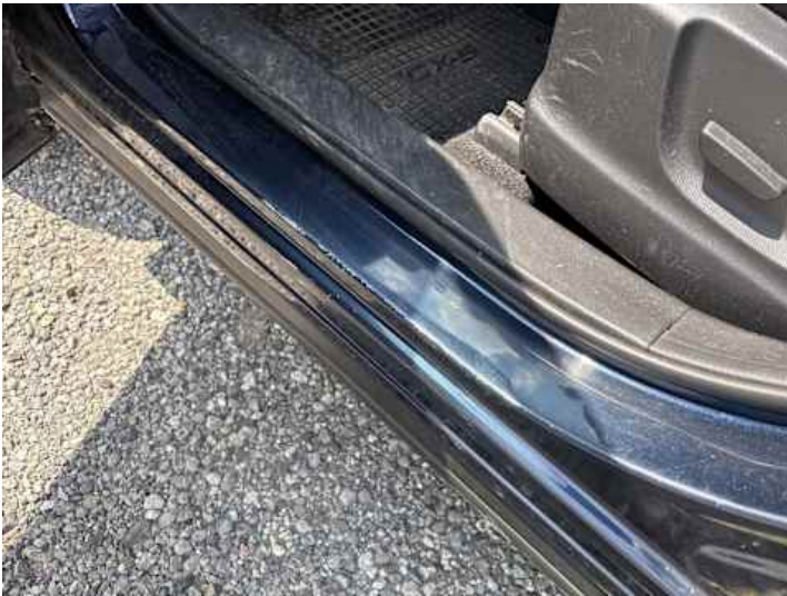
Schweller links (Kratzer, Delle)
