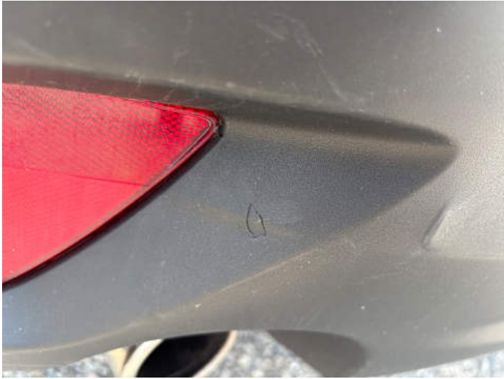
Stoßstange hinten (Riss/Bruch, Verformung)
