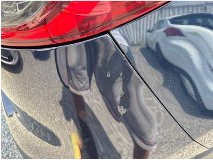
Stoßstange hinten (Riss/Bruch, Verformung)
