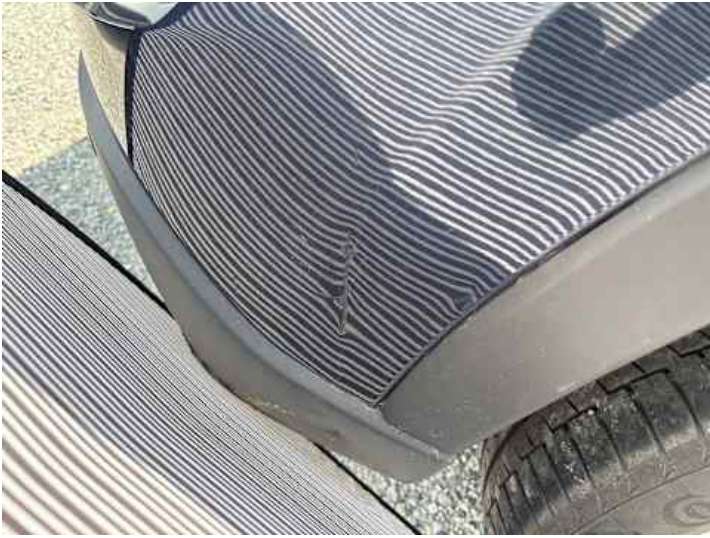
Stoßstange hinten (Riss/Bruch, Verformung)
