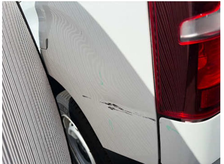
Seitenteil hinten links (Verformung, Lackschaden, Kratzer)
