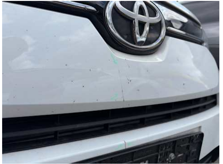
Stoßstange vorne (Riss/Bruch, Kratzer)
