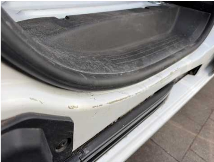
Türe hinten rechts (Kratzer, Lackschaden)
