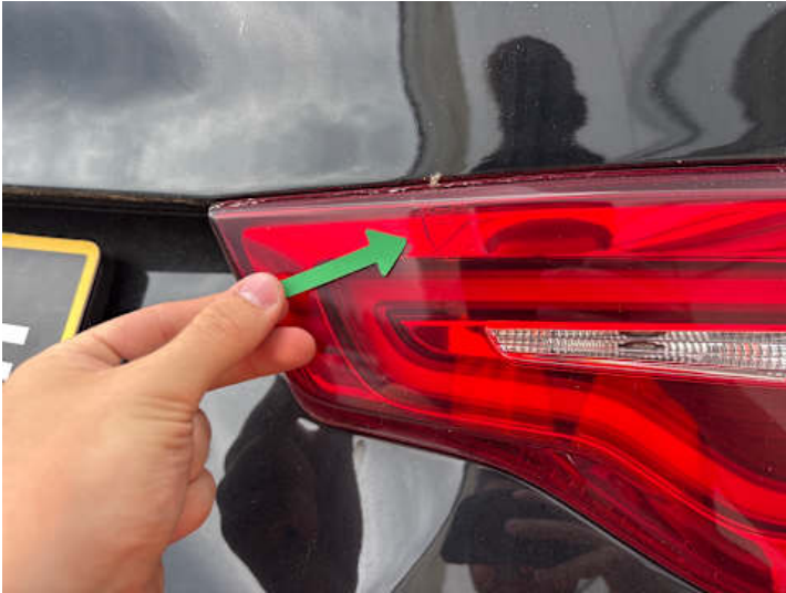
Rücklicht (rechts) (Riss/Bruch)
