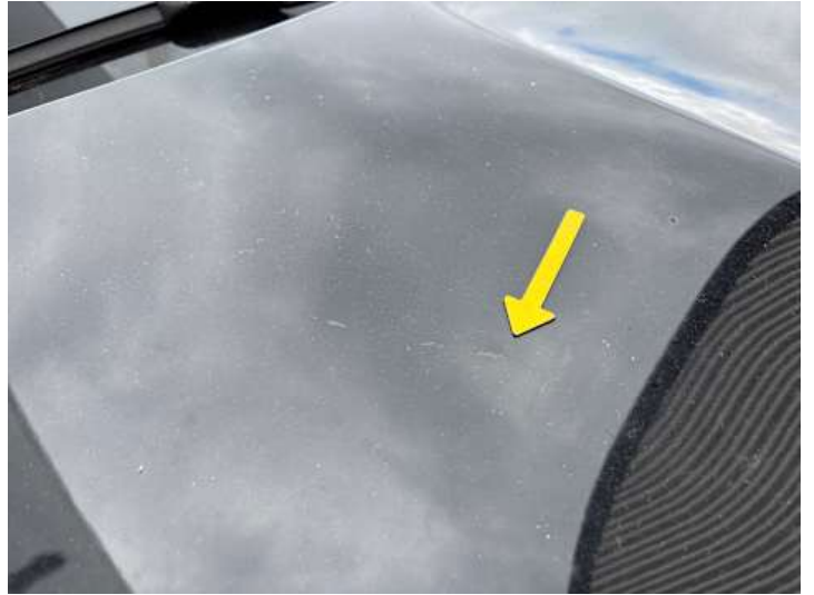
Motorhaube (Kratzer, Lackschaden, Delle, Unsachgemäß instand gesetzt)
