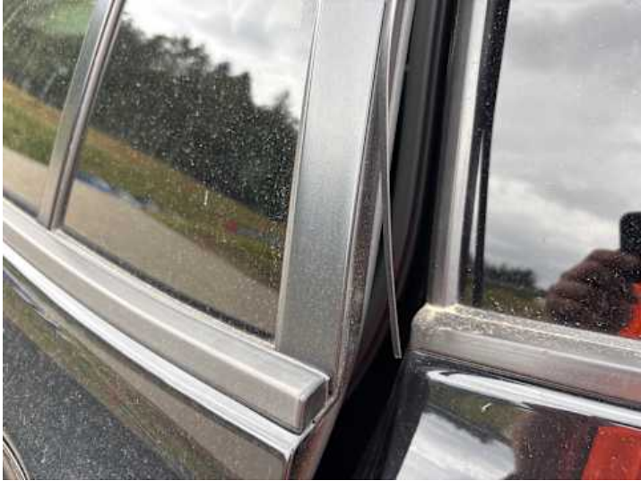
Türe hinten links (Anderer Schaden, Kratzer, Lackschaden, Unsachgemäß instand gesetzt): Dichtung löst sich
