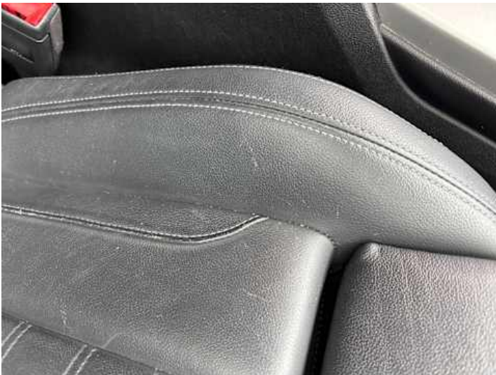
Innenraum (Verschleiß, Kratzer)
