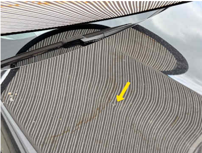
Motorhaube (Kratzer, Lackschaden, Delle, Unsachgemäß instand gesetzt)
