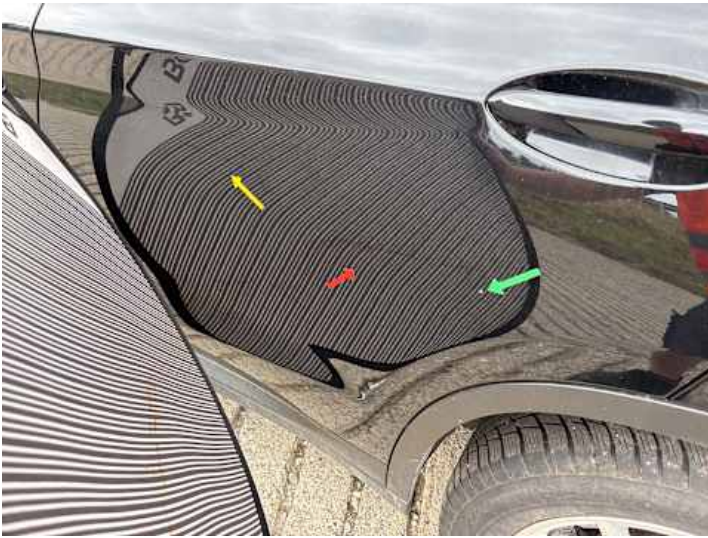
Türe hinten links (Anderer Schaden, Kratzer, Lackschaden, Unsachgemäß instand gesetzt): Dichtung löst sich
