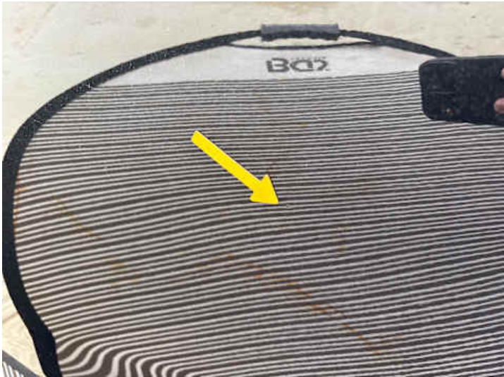
Türe hinten rechts (Delle)
