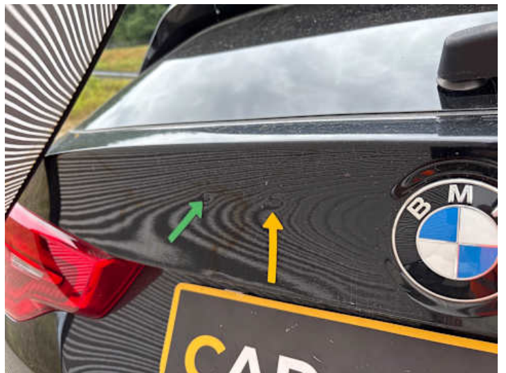
Heckklappe (Lackschaden, Delle, Unsachgemäß instand gesetzt)
