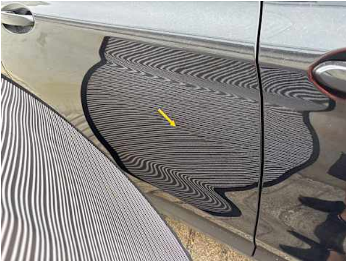
Türe hinten rechts (Delle)
