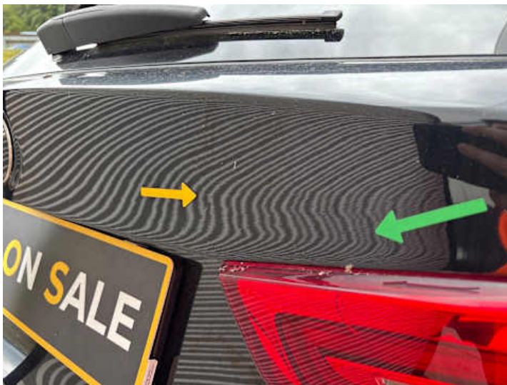
Heckklappe (Lackschaden, Delle, Unsachgemäß instand gesetzt)
