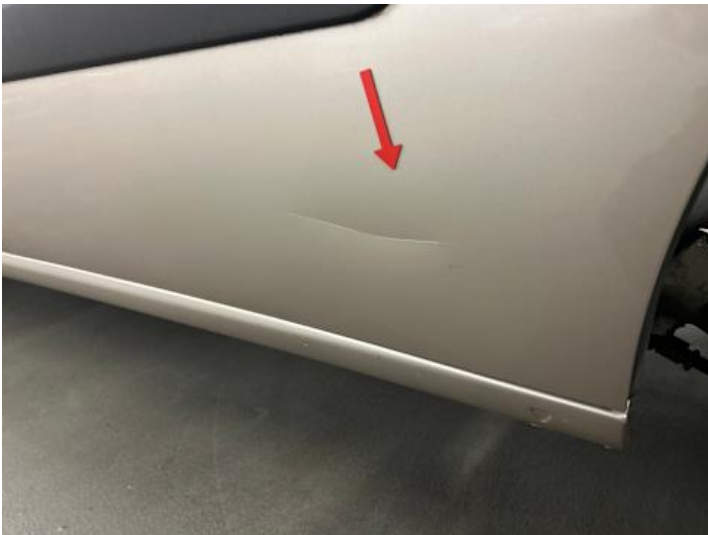
Türe hinten links (Delle, Kratzer)
