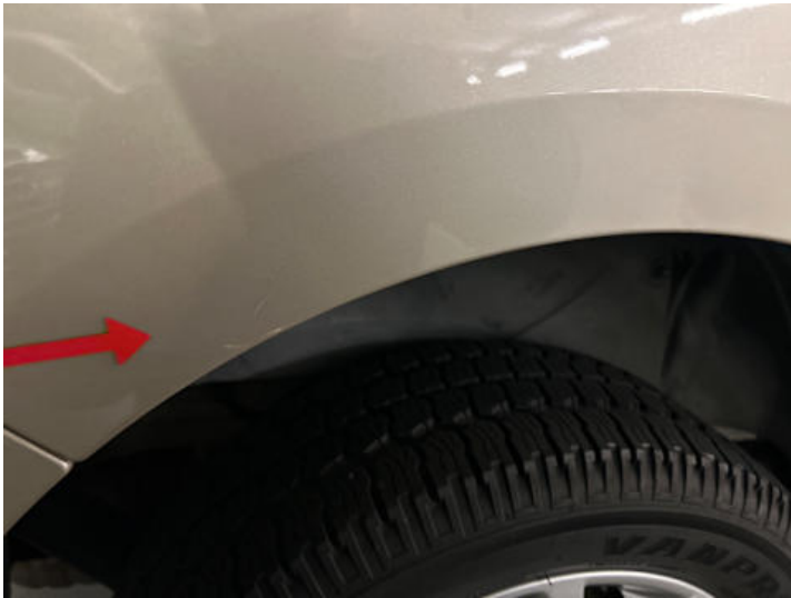
Seitenteil hinten rechts (Kratzer)
