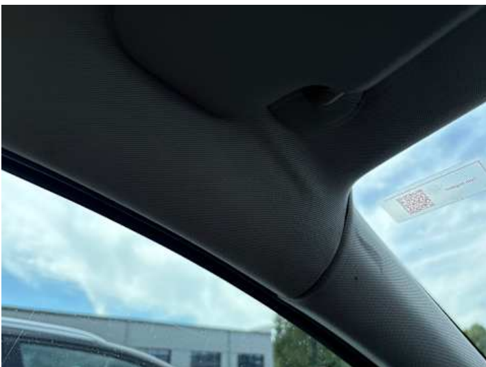
Innenraum (Anderer Schaden): Stoffablösung
