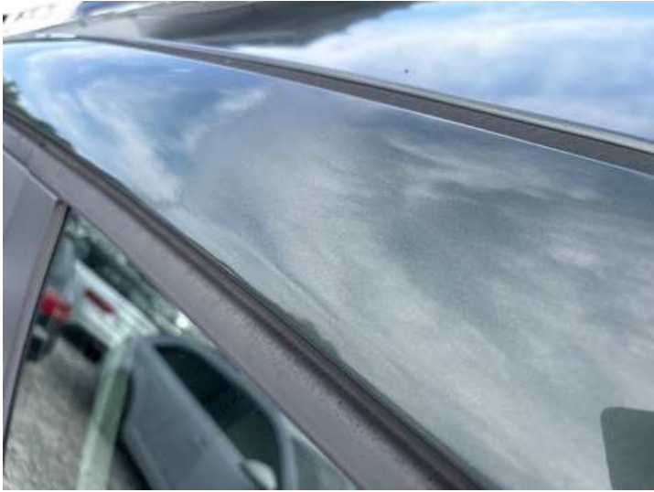
Seitenteil hinten links (Lackschaden)
