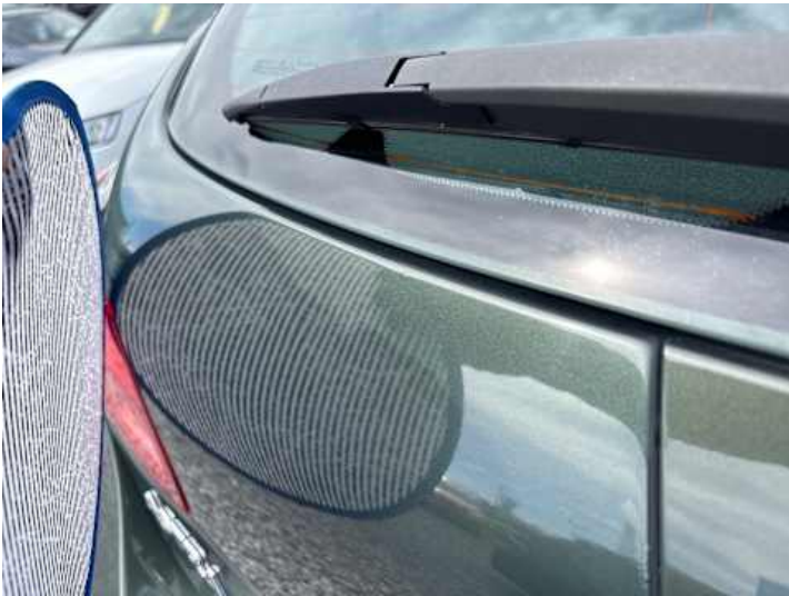
Heckklappe (Delle, Lackschaden, Rost)
