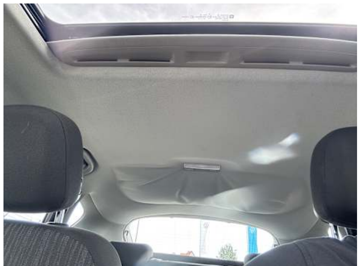
Innenraum (Anderer Schaden): Stoffablösung
