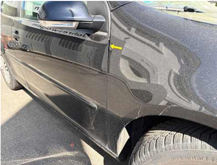
Kotflügel vorne rechts (Spaltmaße ungenau)
