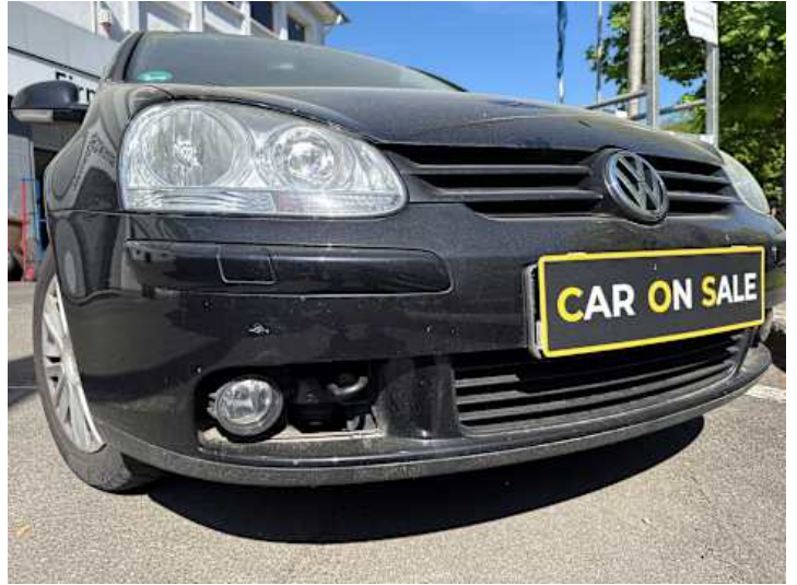
Stoßstange vorne (Anderer Schaden): Fehlende Abdeckung
