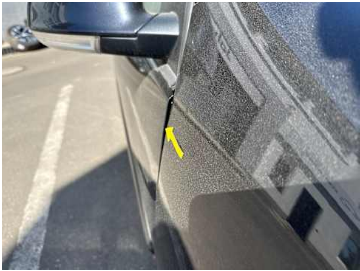
Kotflügel vorne rechts (Spaltmaße ungenau)
