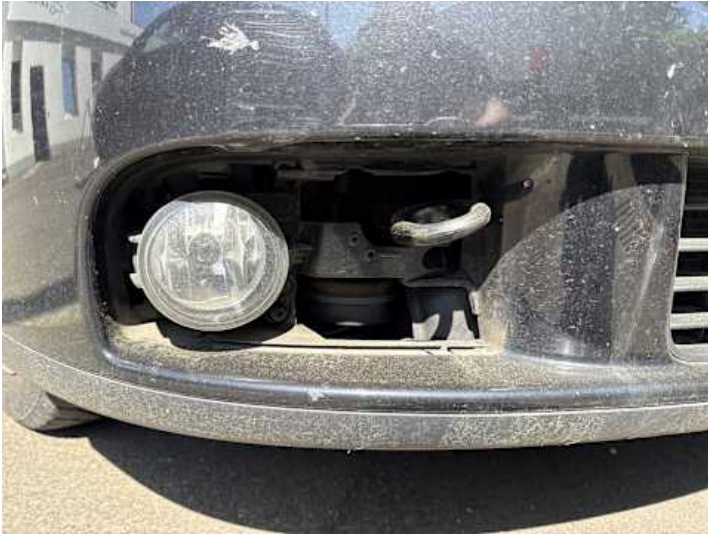
Stoßstange vorne (Anderer Schaden): Fehlende Abdeckung
