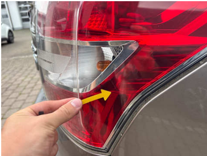
Rücklicht (rechts) (Kratzer)
