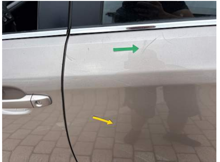
Türe hinten links (Lackschaden, Rost, Kratzer)
