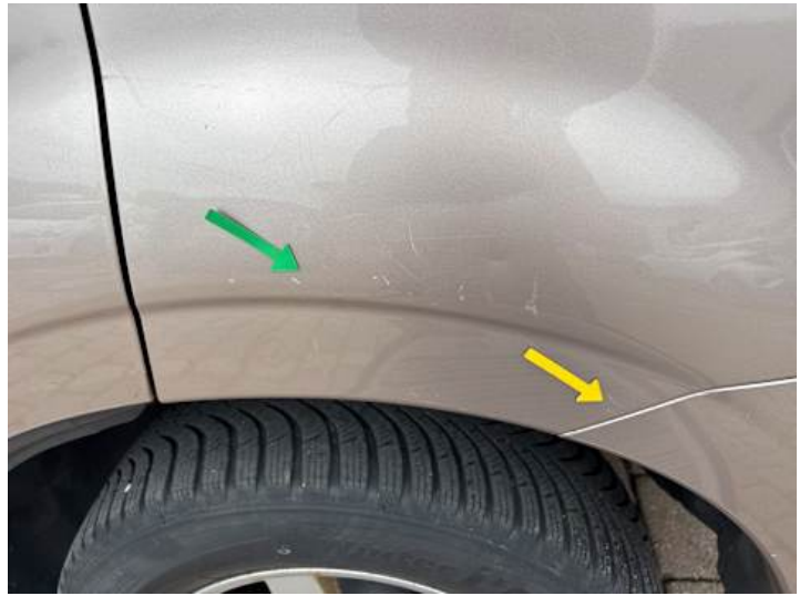
Seitenteil hinten links (Kratzer, Delle, Lackschaden)
