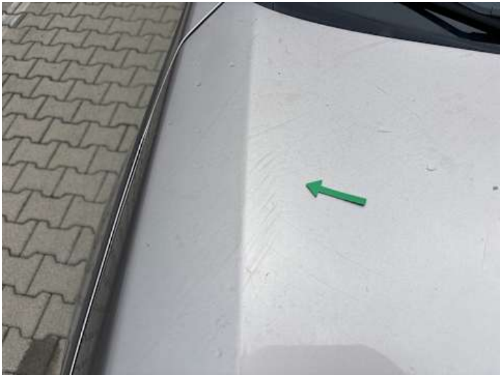
Motorhaube (Kratzer, Lackschaden)
