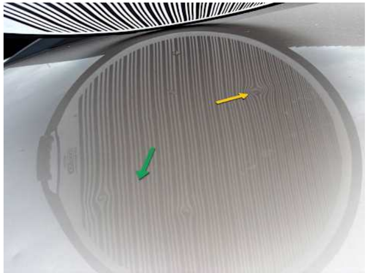
Dach (Delle, Kratzer)
