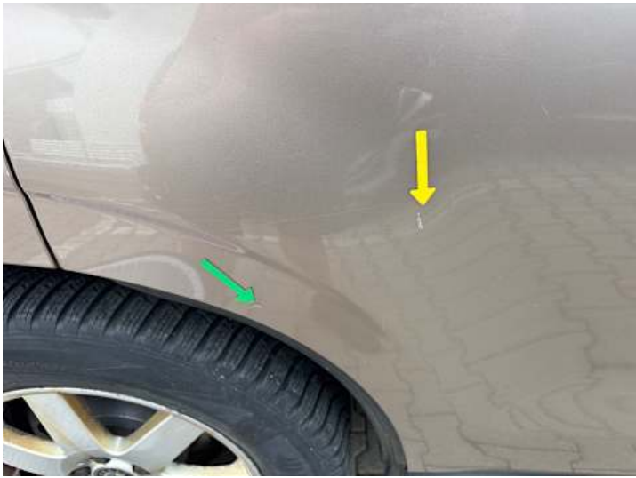
Türe hinten rechts (Lackschaden, Rost, Delle, Kratzer)
