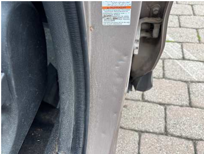
Schweller links (Lackschaden, Rost, Kratzer, Delle)
