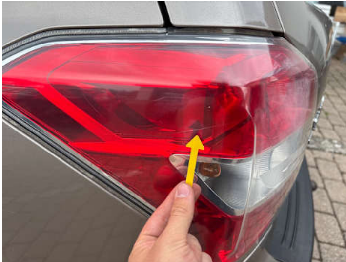
Rücklicht (links) (Kratzer, Blind)
