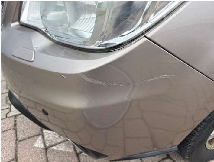
Stoßstange vorne (Kratzer, Lackschaden)
