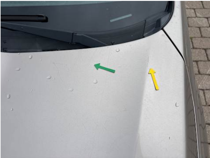
Motorhaube (Kratzer, Lackschaden)
