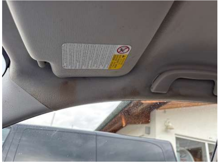
Innenraum (Verschmutzung, Kratzer, Verschleiß, Anderer Schaden): Korrossion
