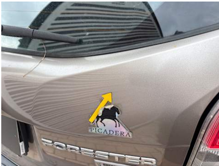
Heckklappe (Unsachgemäß instand gesetzt, Lackschaden, Ausgeblichen/Matt)
