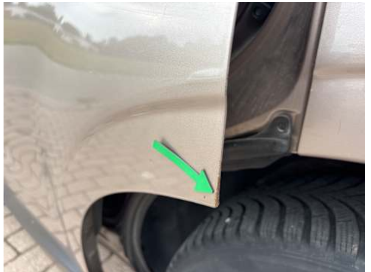
Türe hinten links (Lackschaden, Rost, Kratzer)
