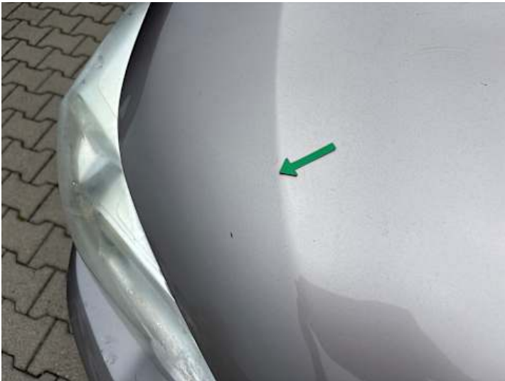
Motorhaube (Kratzer, Lackschaden)
