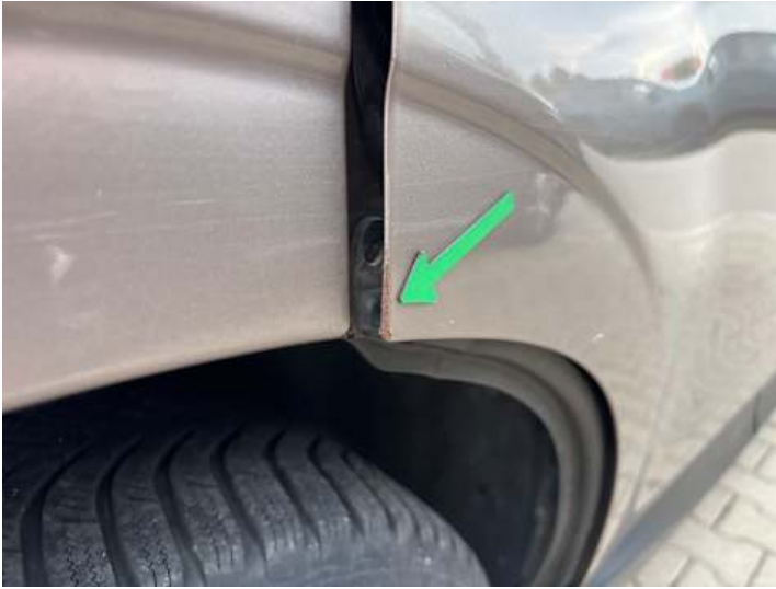
Türe hinten rechts (Lackschaden, Rost, Delle, Kratzer)
