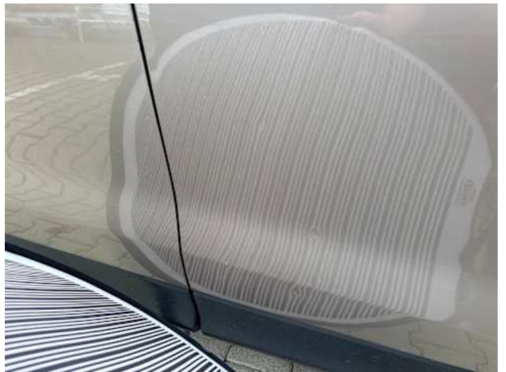
Beifahrertür (Kratzer, Delle, Lackschaden)
