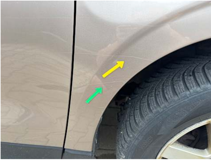
Kotflügel vorne rechts (Kratzer)
