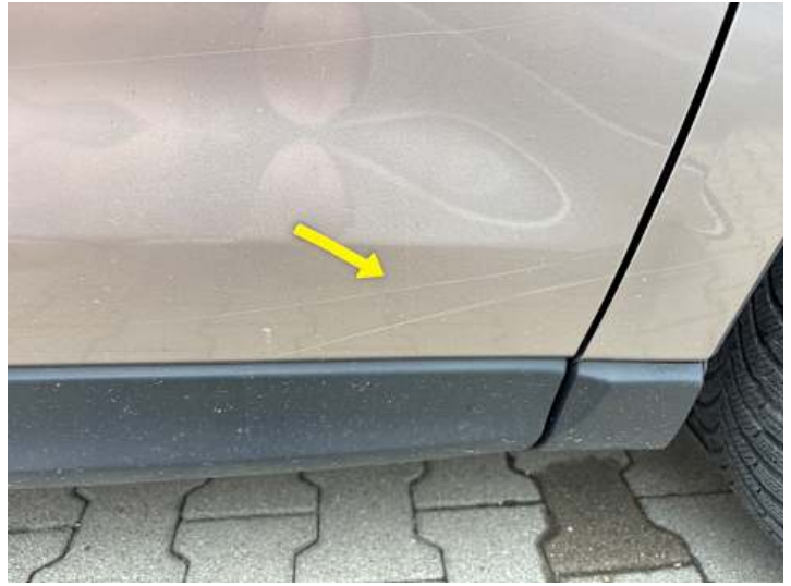
Beifahrtür (Kratzer, Delle, Lackschaden)
