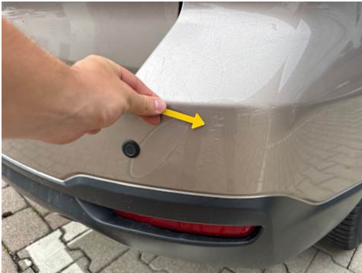
Stoßstange hinten (Kratzer, Lackschaden)
