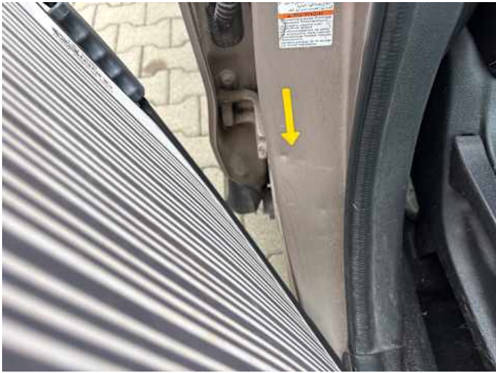
Schweller rechts (Kratzer, Lackschaden, Delle)
