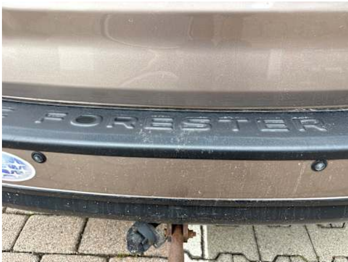
Stoßstange hinten (Kratzer, Lackschaden)
