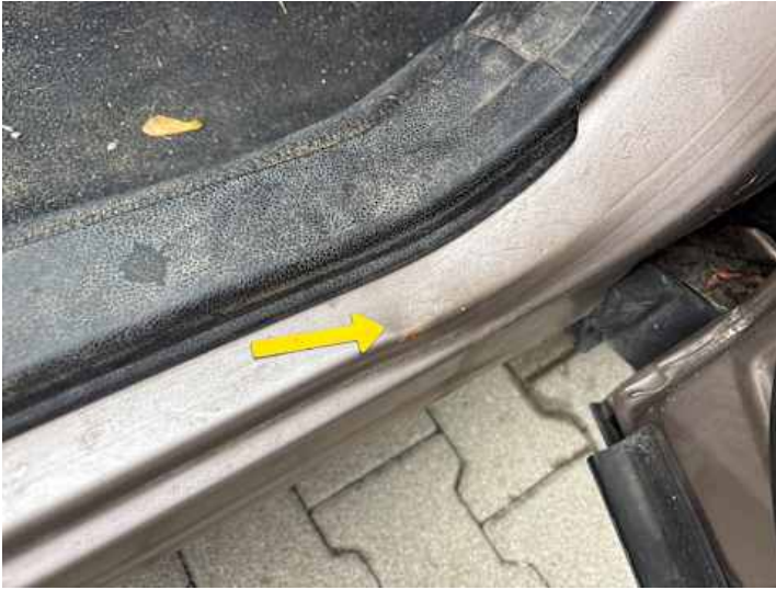
Schweller rechts (Verformung, Lackschaden, Rost)
