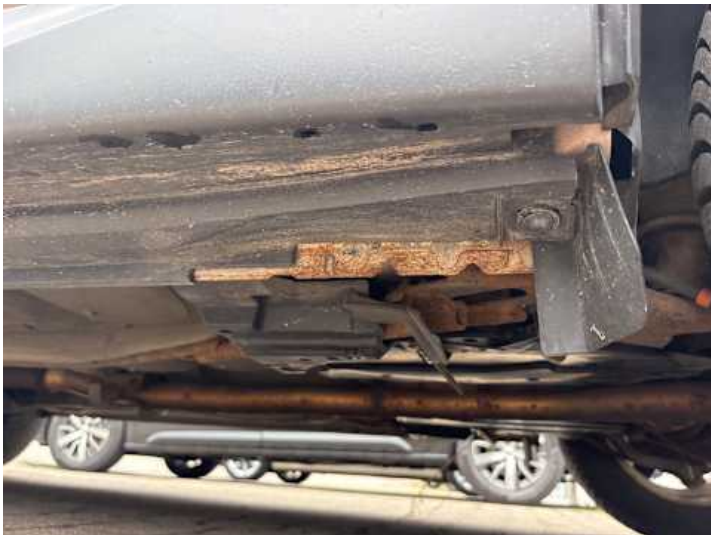
Schweller links (Lackschaden, Rost, Kratzer, Delle)
