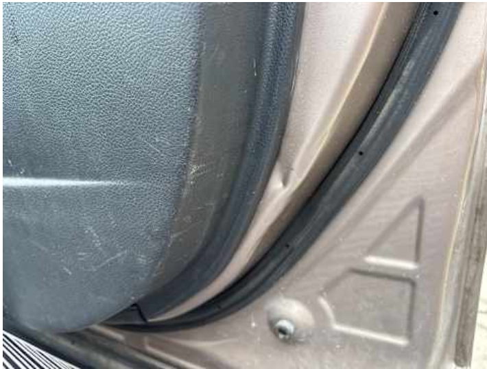
Beifahrertür (Verformung, Lackschaden)
