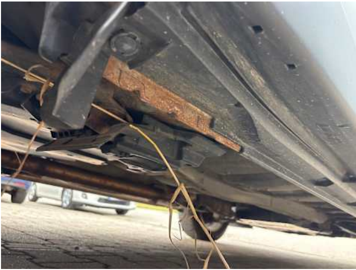
Schweller rechts (Lackschaden, Rost)
