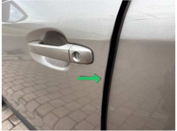
Fahrtür (Kratzer, Lackschaden, Rost, Delle)
