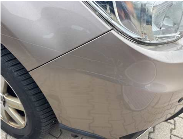
Stoßstange vorne (Kratzer, Lackschaden)
