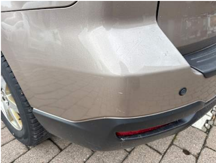
Stoßstange hinten (Kratzer, Lackschaden)
