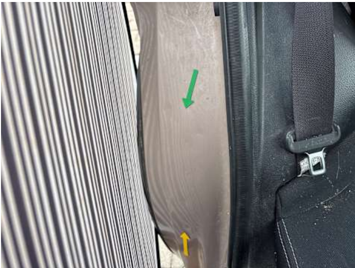
Seitenteil hinten rechts (Kratzer, Delle)
