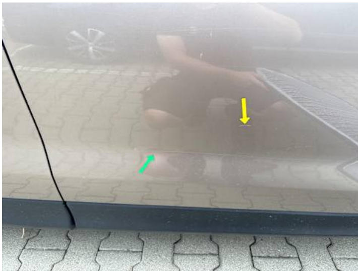
Beifahrertür (Kratzer, Delle, Lackschaden)
