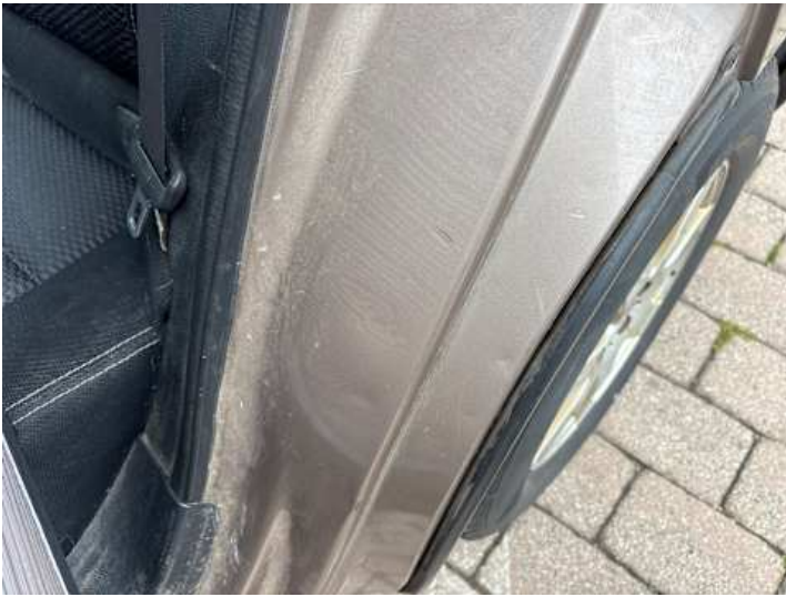
Seitenteil hinten links (Kratzer, Delle, Lackschaden)
