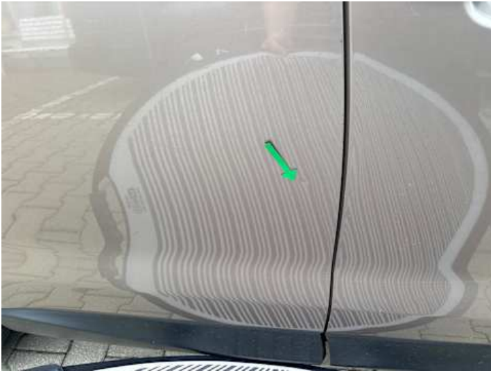
Türe hinten rechts (Lackschaden, Rost, Delle, Kratzer)
