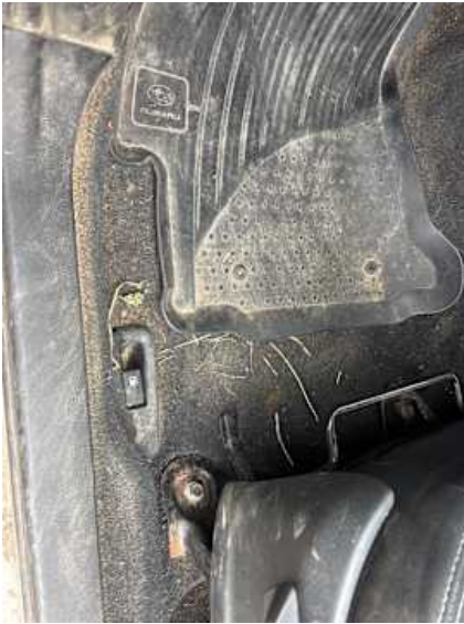
Innenraum (Verschmutzung, Kratzer, Verschleiß, Anderer Schaden): Korrossion
