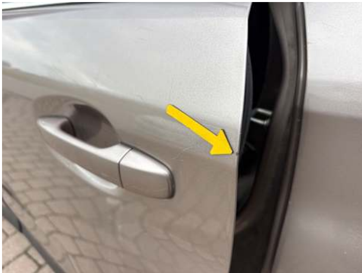
Türe hinten links (Lackschaden, Rost, Kratzer)
