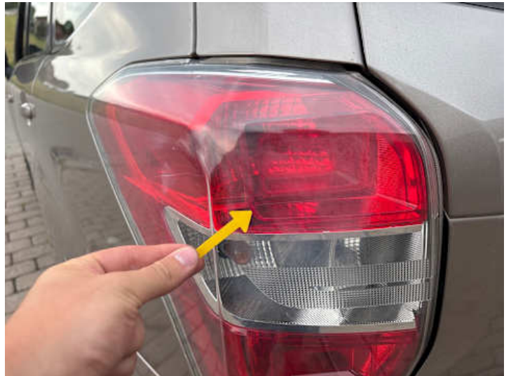
Rücklicht (links) (Kratzer, Blind)
