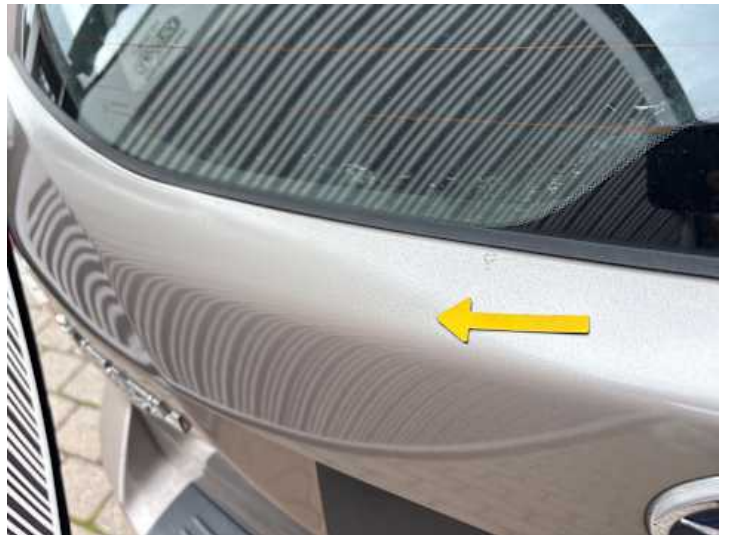
Heckklappe (Unsachgemäß instand gesetzt, Lackschaden, Ausgeblichen/Matt)
