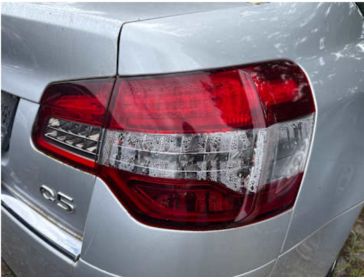
Rücklicht (rechts) (Undicht)
