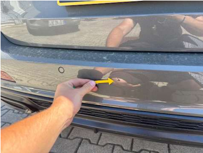
Stoßstange hinten (Kratzer, Lackschaden)
