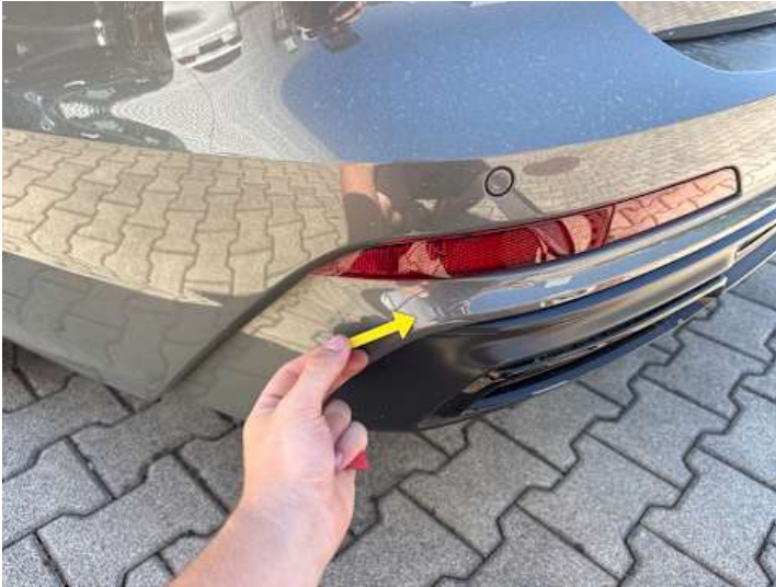
Stoßstange hinten (Kratzer, Lackschaden)
