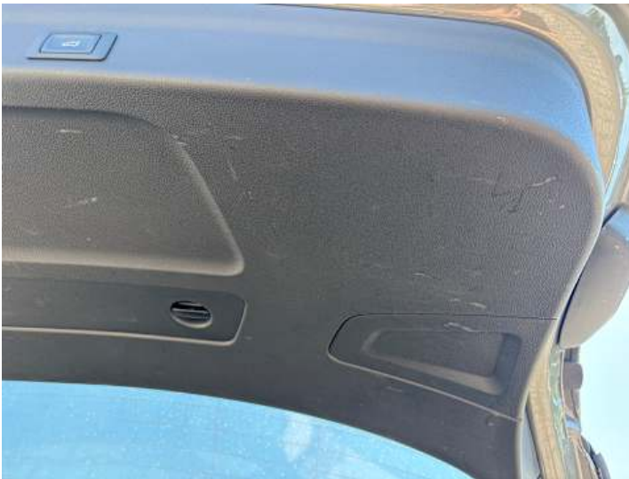
Innenraum (Verschmutzung, Kratzer)
