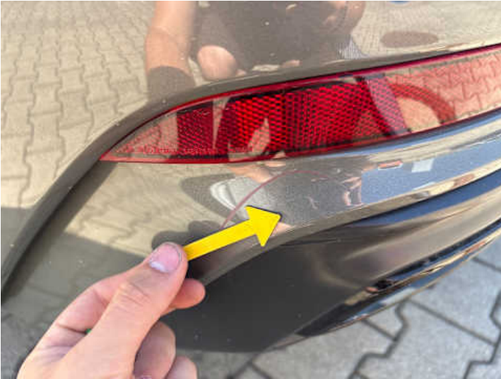
Stoßstange hinten (Kratzer, Lackschaden)
