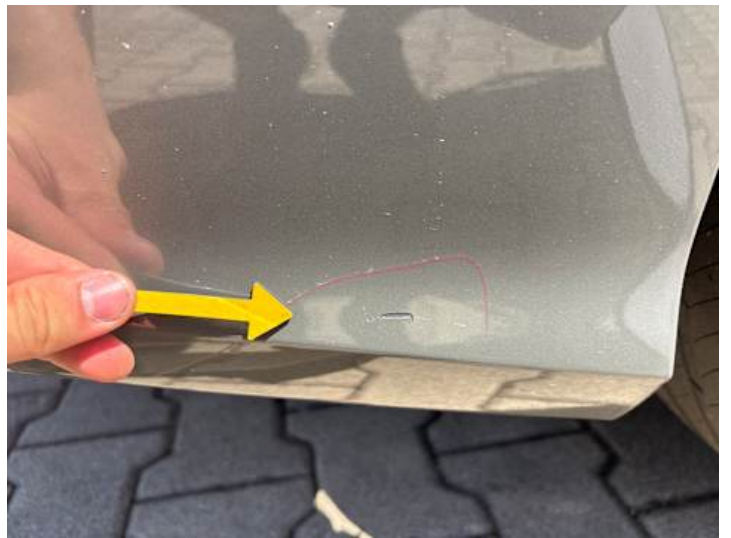
Stoßstange hinten (Kratzer, Lackschaden)
