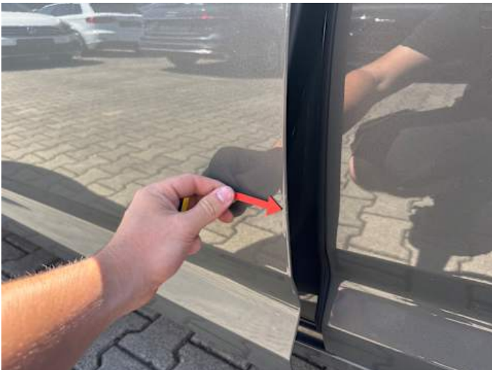
Fahrtür (Kratzer, Lackschaden, Anderer Schaden): Vogelkot
