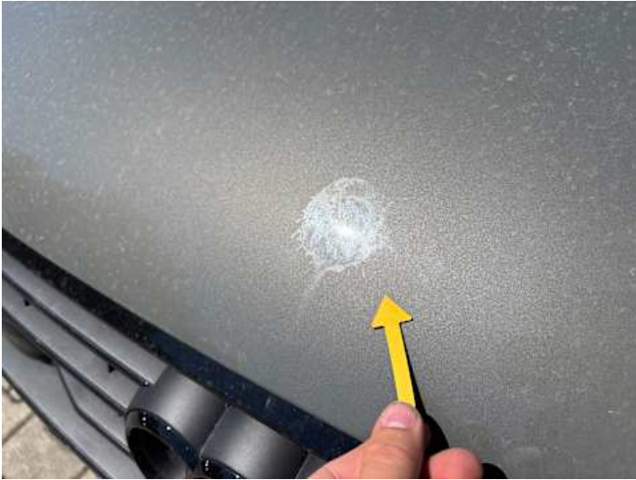
Motorhaube (Anderer Schaden): Vogelkot
