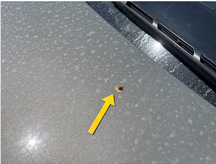
Motorhaube (Anderer Schaden): Vogelkot
