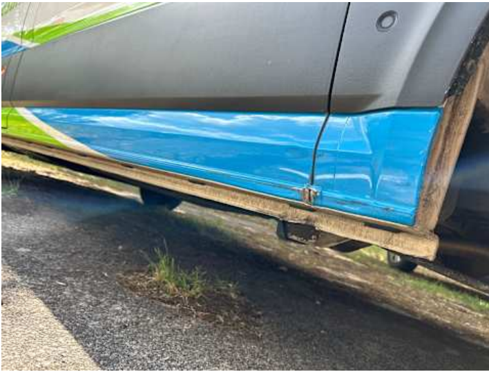
Schweller links (Verformung, Lackschaden)
