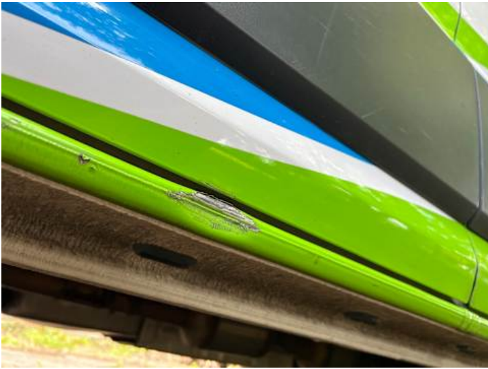
Türe hinten rechts (Kratzer, Lackschaden)
