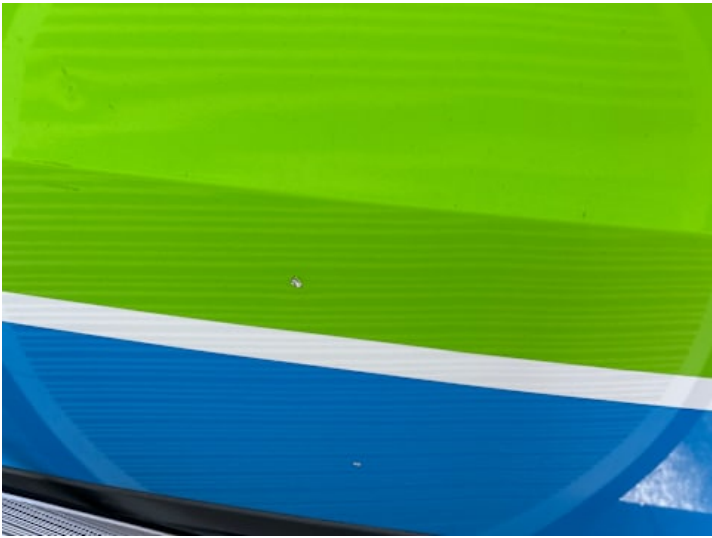
Heckklappe (Delle, Kratzer, Lackschaden)
