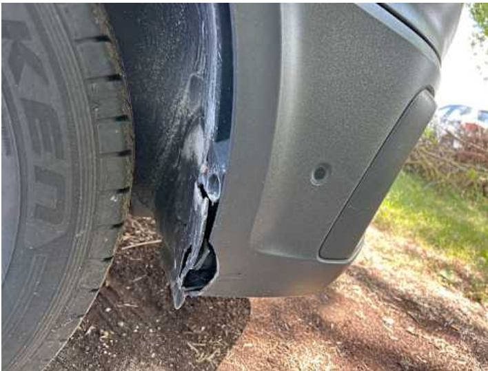
Stoßstange vorne (Riss/Bruch)
