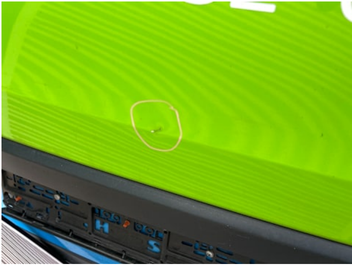
Heckklappe (Delle, Kratzer, Lackschaden)
