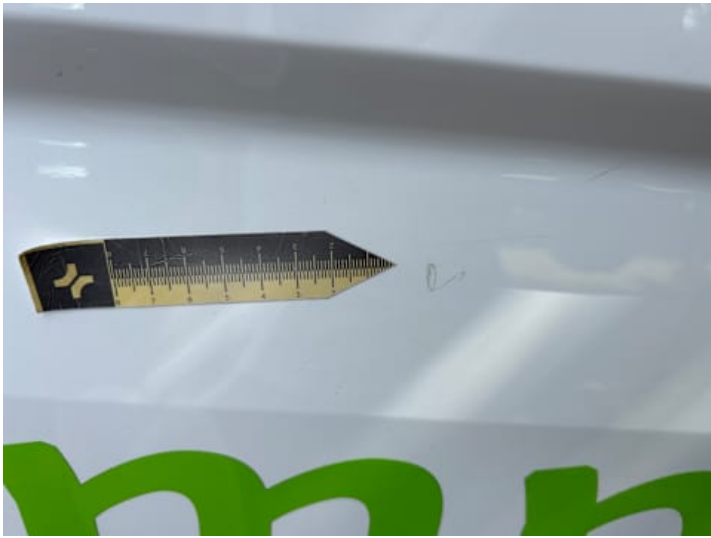
Türe hinten rechts (Kratzer, Lackschaden)
