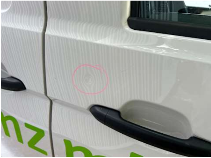
Beifahrtür (Delle, Lackschaden)
