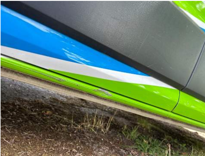
Schweller rechts (Verformung, Lackschaden)
