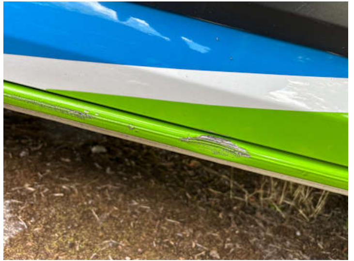
Schweller rechts (Verformung, Lackschaden)
