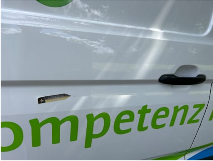
Türe hinten rechts (Kratzer, Lackschaden)
