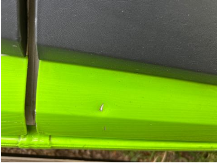
Beifahrtür (Delle, Lackschaden)
