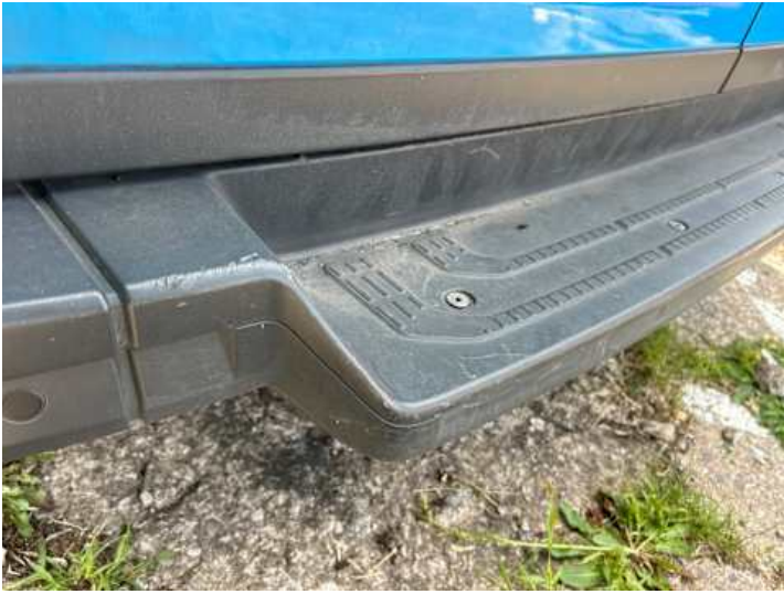
Stoßstange hinten (Kratzer)
