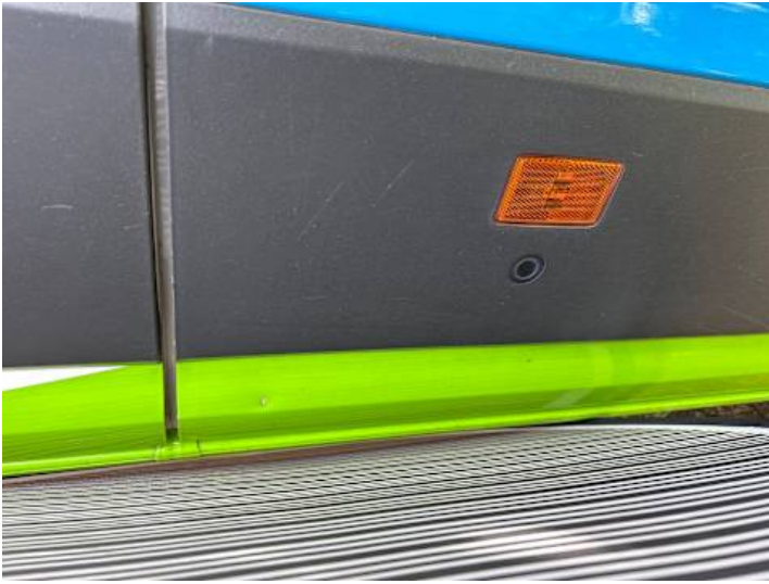
Beifahrtür (Delle, Lackschaden)
