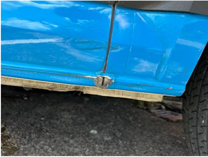
Schweller links (Verformung, Lackschaden)
