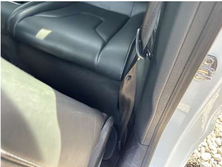
Innenraum (Anderer Schaden): Fahrergurt verdreht
