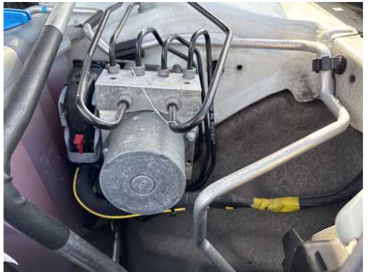
Innenraum (Anderer Schaden): Kabelreparatur am ABS System
