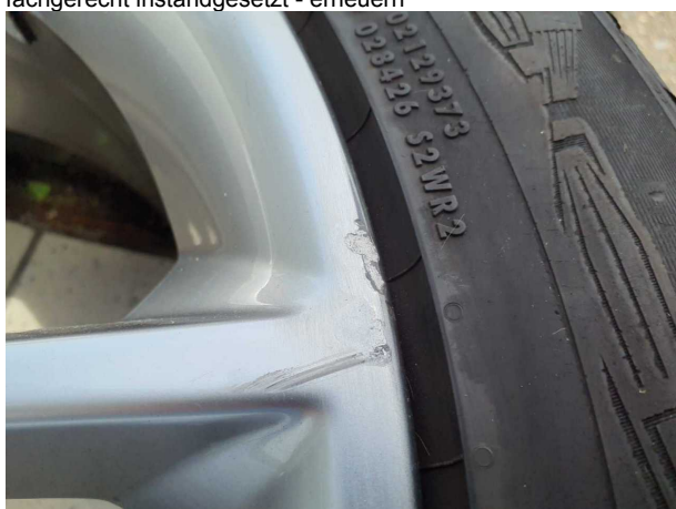
Beschädigung #17: 2.Radsatz: 2 Leichtmetallfelgen - nicht fachgerecht instandgesetzt - erneuern
