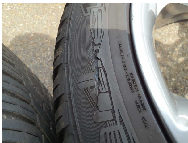
Beschädigung #15: 2.Radsatz: 3 Reifen - beschädigt - erneuern
