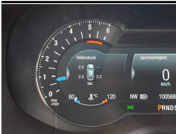
Beschädigung #7: Rad/Reifen: Drucksensor - leuchtet - Diagnose durchführen
