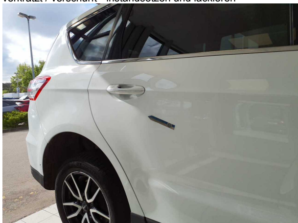
Beschädigung #12: Tür hinten rechts: Tür - verformt - instandsetzen und lackieren
