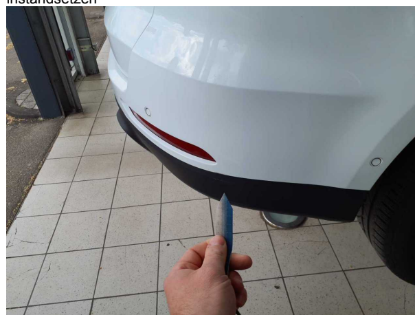
Beschädigung #2: Stossfänger hinten: Spoiler - Kratzer - Wertminderung
