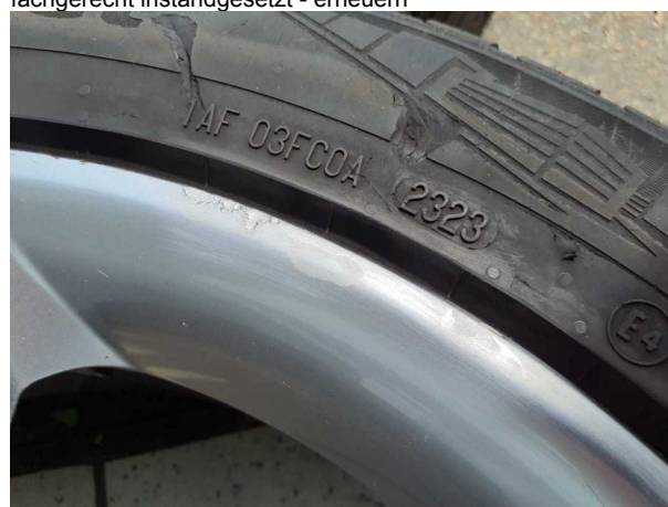
Beschädigung #17: 2.Radsatz: 2 Leichtmetallfelgen - nicht fachgerecht instandgesetzt - erneuern
