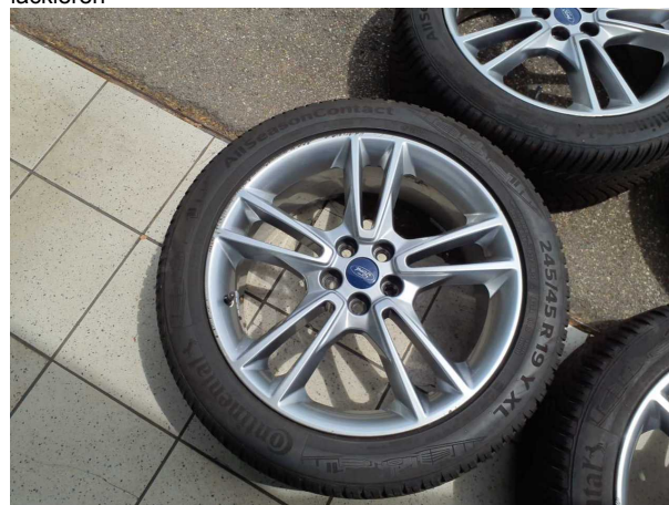
Beschädigung #9: 2.Radsatz: 2 Leichtmetallfelgen - verkratzt... verschürft - Wertminderung
