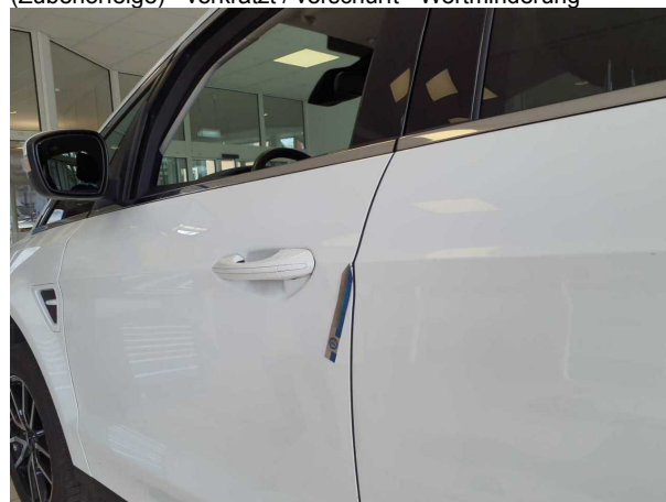
Beschädigung #6: Tür vorn links: Türkante (Bis auf Metall) - Kratzer - Smart Repair
