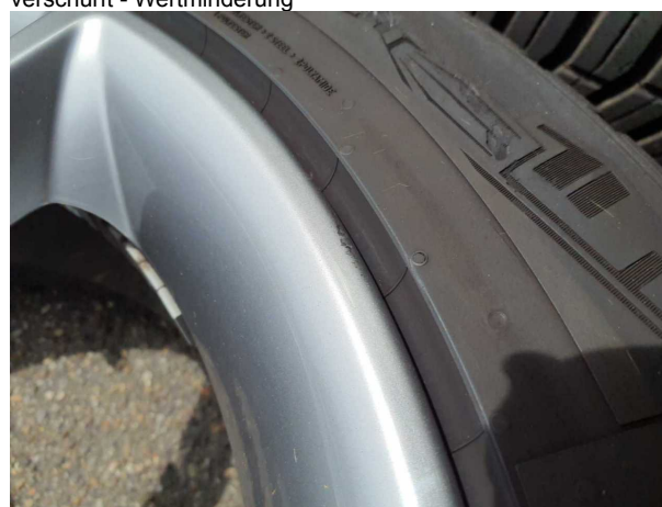
Beschädigung #9: 2.Radsatz: 2 Leichtmetallfelgen - verkratzt / verschürft - Wertminderung
