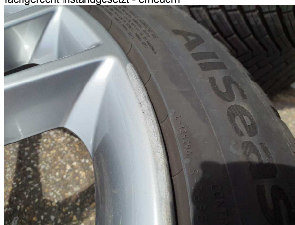
Beschädigung #17: 2.Radsatz: 2 Leichtmetallfelgen - nicht fachgerecht instandgesetzt - erneuern
