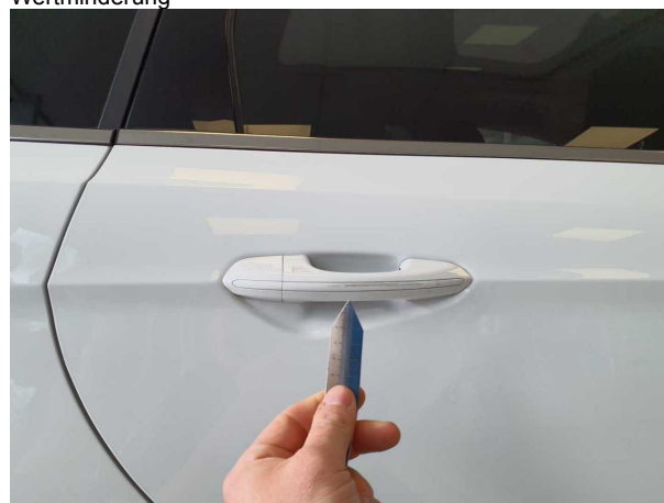
Beschädigung #3: Tür hinten rechts: Griff außen - verkratzt / verschürft - lackieren
