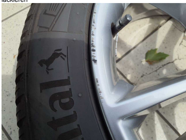
Beschädigung #9: 2.Radsatz: 2 Leichtmetallfelgen - verkratzt / verschürft - Wertminderung
