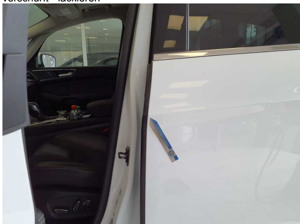
Beschädigung #4: Tür hinten links: Türdichtung - beschädigt - erneuern
