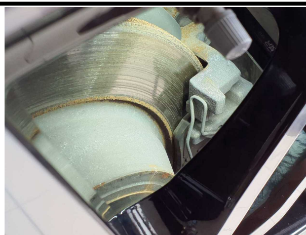
Beschädigung #11: Bremsanlage: Bremsscheiben und Beläge hinten - verschlissen - erneuern
