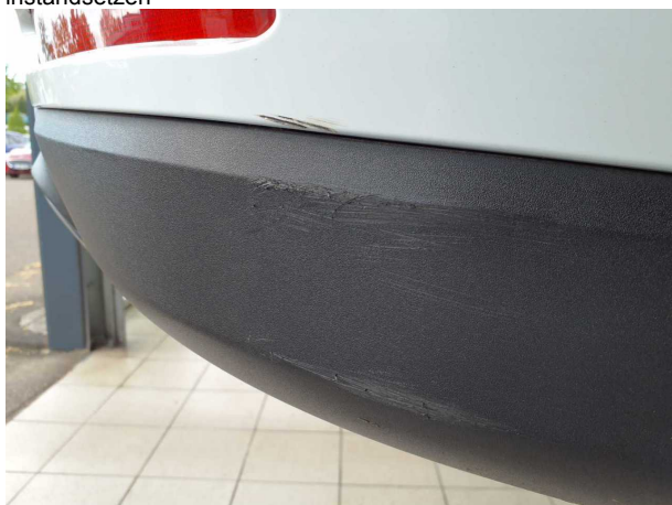
Beschädigung #2: Stossfänger hinten: Spoiler - Kratzer - Wertminderung
