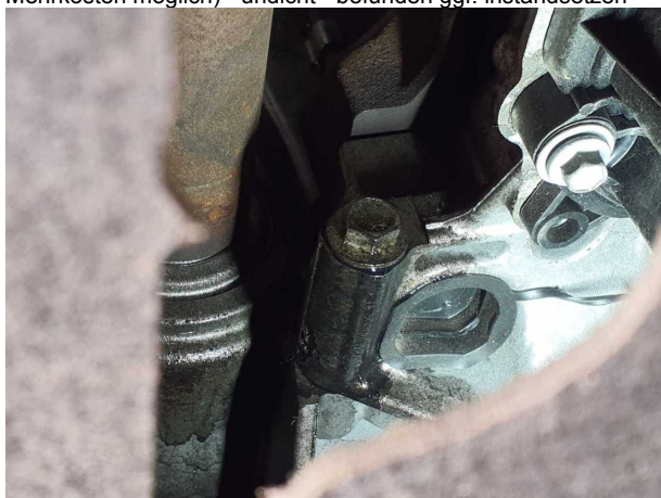
Beschädigung #18: Motor: Motor (Werkstattprüfung erforderlich, Mehrkosten möglich) - undicht - befunden ggf. instandsetzen
