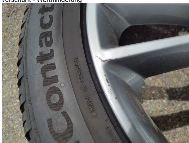
Beschädigung #9: 2.Radsatz: 2 Leichtmetallfelgen - verkratzt / verschürft - Wertminderung
