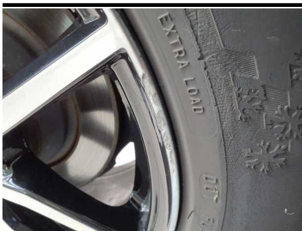
Beschädigung #5: Rad/Reifen: Leichtmetallfelge hinten rechts (Zubehörfelge) - verkratzt / verschürft - Wertminderung
