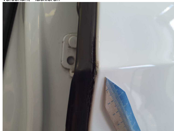
Beschädigung #4: Tür hinten links: Türdichtung - beschädigt - erneuern
