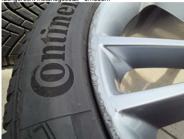
Beschädigung #17: 2.Radsatz: 2 Leichtmetallfelgen - nicht fachgerecht instandgesetzt - erneuern
