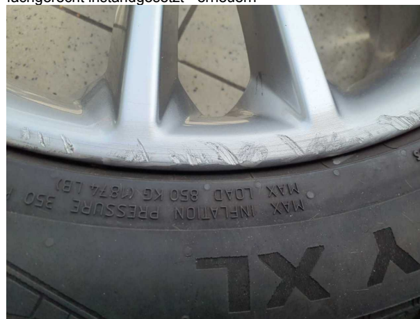
Beschädigung #17: 2.Radsatz: 2 Leichtmetallfelgen - nicht fachgerecht instandgesetzt - erneuern
