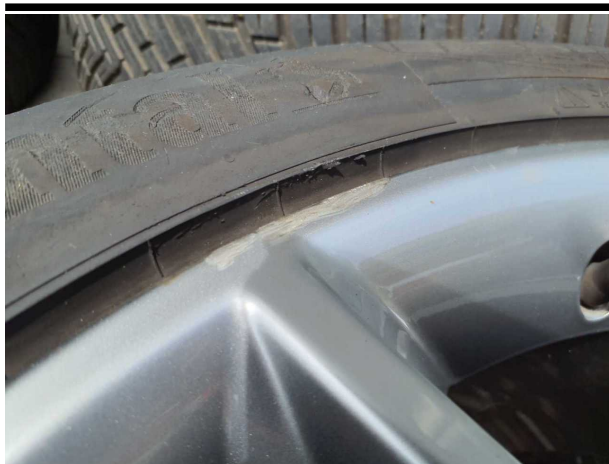
Beschädigung #17: 2.Radsatz: 2 Leichtmetallfelgen - nicht fachgerecht instandgesetzt - erneuern
