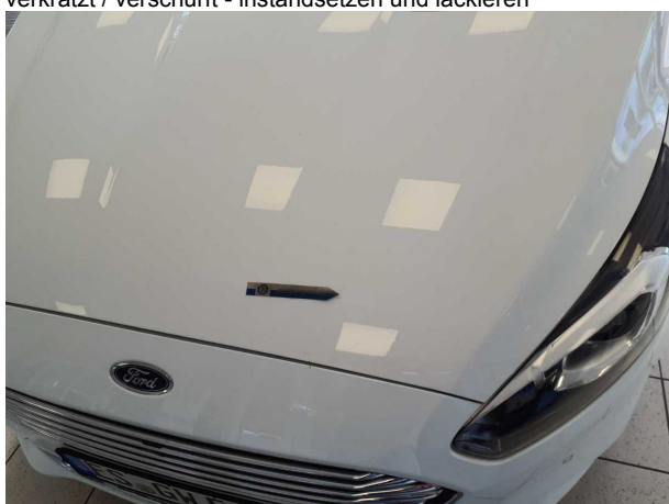
Beschädigung #14: Motorhaube: Motorhaube - Steinschlag - lackieren
