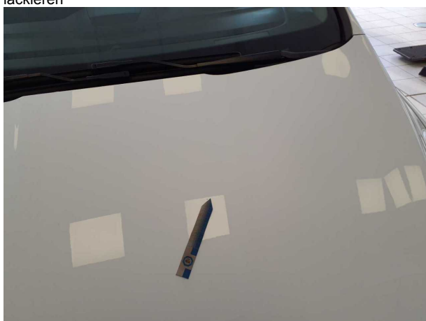
Beschädigung #14: Motorhaube: Motorhaube - Steinschlag - lackieren
