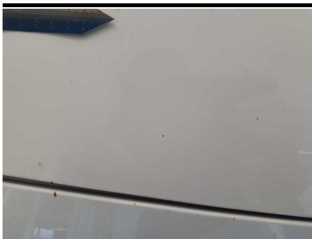
Beschädigung #14: Motorhaube: Motorhaube - Steinschlag - lackieren
