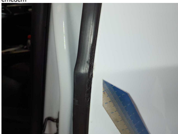
Beschädigung #4: Tür hinten links: Türdichtung - beschädigt - erneuern
