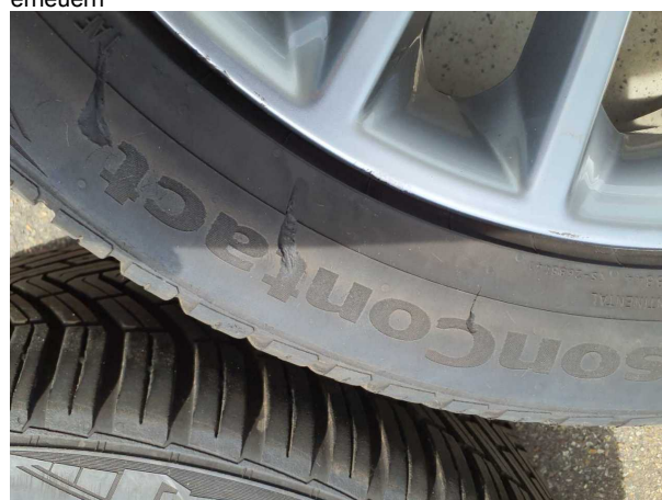
Beschädigung #15: 2.Radsatz: 3 Reifen - beschädigt - erneuern
