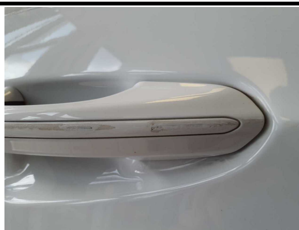
Beschädigung #3: Tür hinten rechts: Griff außen - verkratzt / verschürft - lackieren
