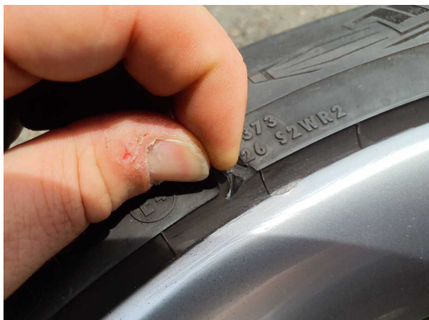
Beschädigung #15: 2.Radsatz: 3 Reifen - beschädigt - erneuern
