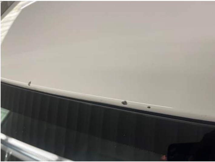
Dach (Lackschaden, Rost)
