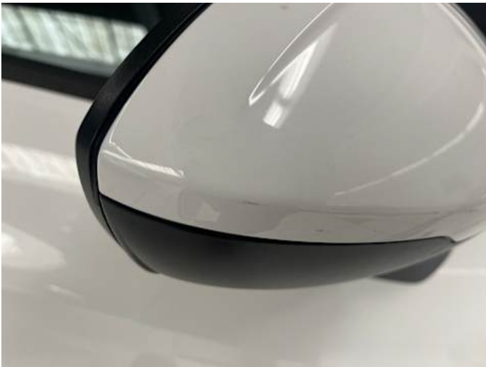
Beifahrtür (Kratzer, Lackschaden)
