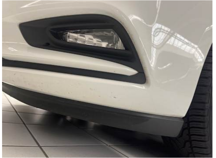
Stoßstange vorne (Kratzer, Lackschaden)
