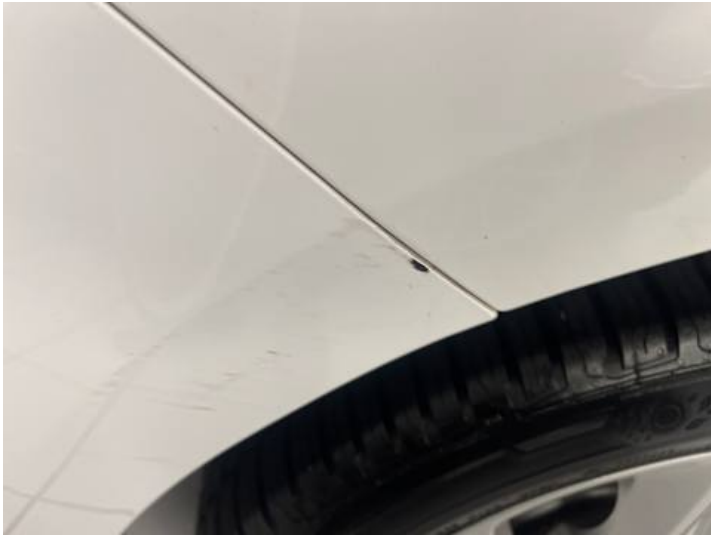
Stoßstange hinten (Kratzer, Lackschaden)
