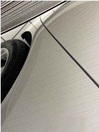
Seitenteil hinten links (Delle)
