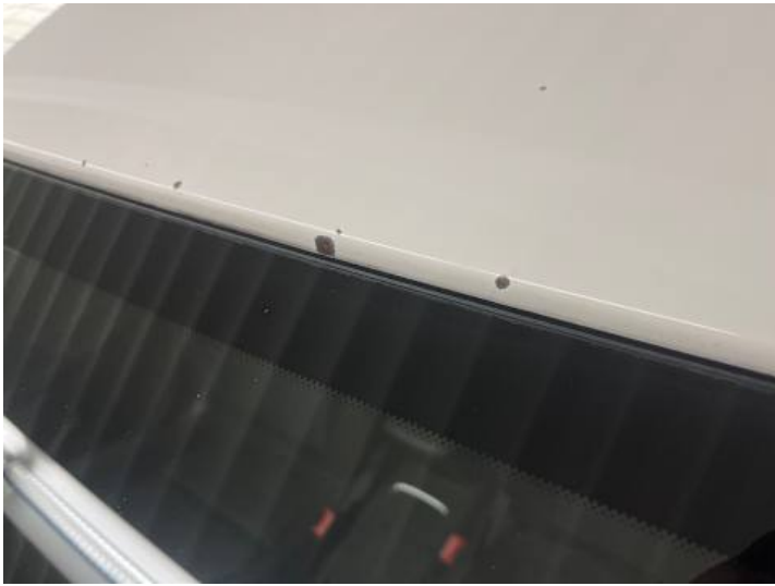
Dach (Lackschaden, Rost)
