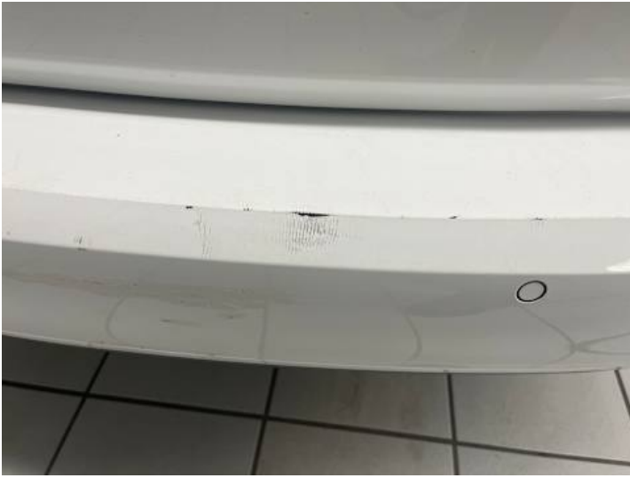
Stoßstange hinten (Kratzer, Lackschaden)
