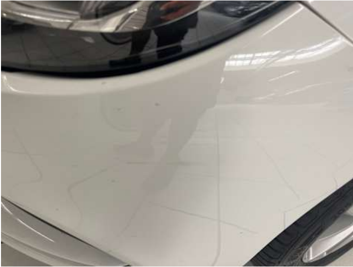
Stoßstange vorne (Kratzer, Lackschaden)
