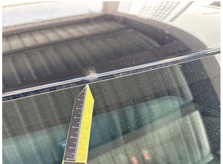
Dach (Rost, Lackschaden)
