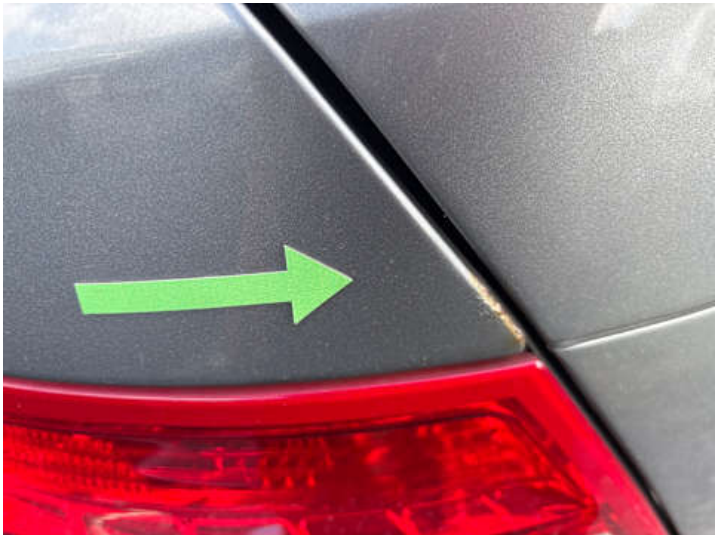
Seitenteil hinten links (Rost, Delle)
