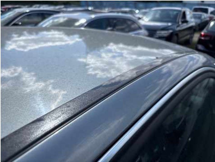
Dach (Lackschaden, Kratzer)
