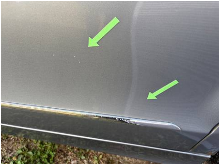
Türe hinten links (Kratzer)
