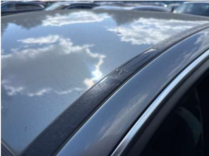
Dach (Lackschaden, Kratzer)
