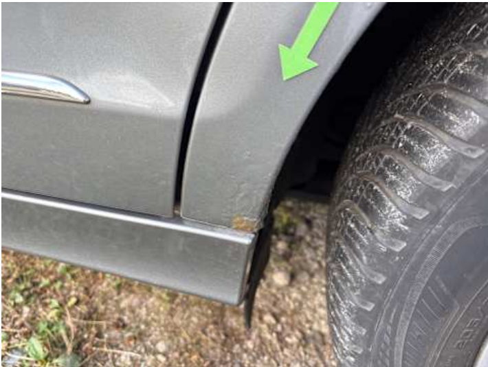
Seitenteil hinten links (Rost, Delle)
