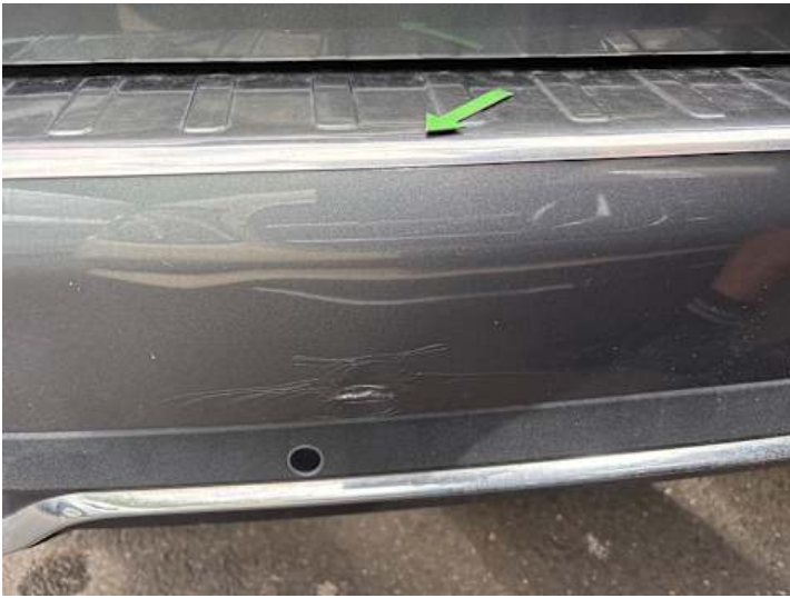
Stoßstange hinten (Riss/Bruch, Lackschaden)
