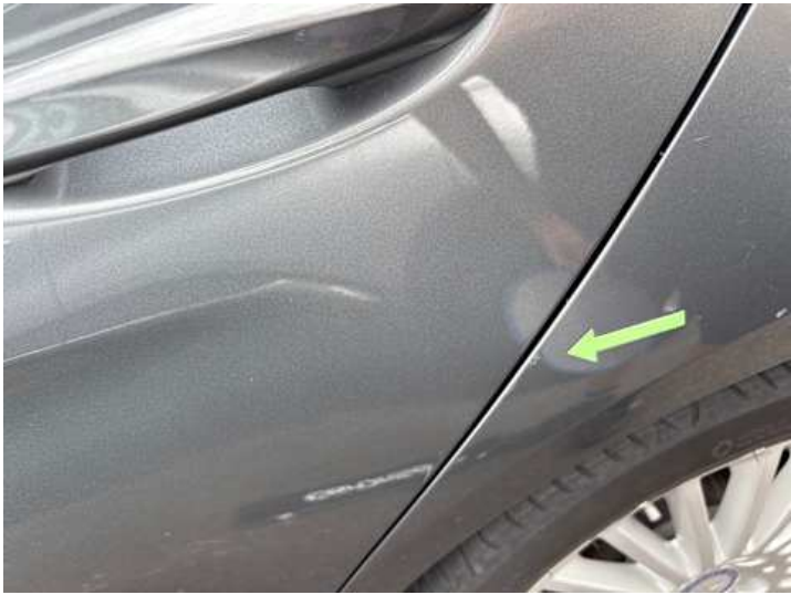
Seitenteil hinten links (Kratzer)
