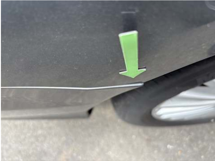
Stoßstange hinten (Spaltmaße ungenau)
