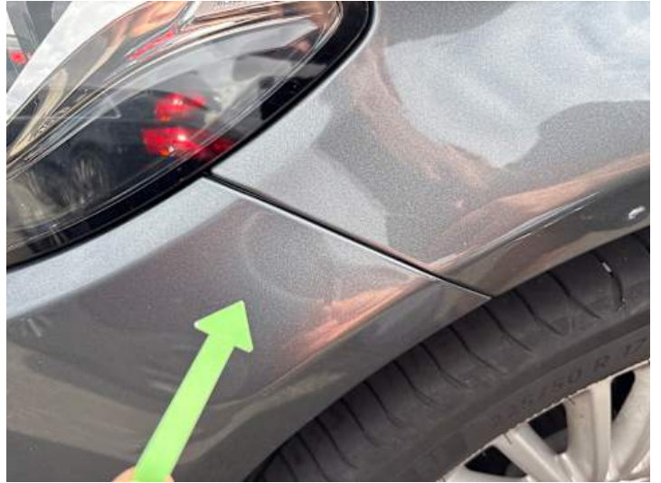
Stoßstange vorne (Spaltmaße ungenau)
