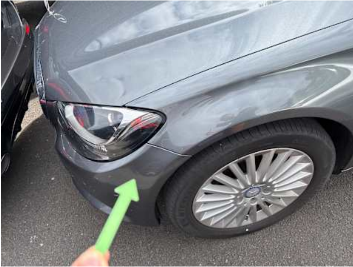
Stoßstange vorne (Spaltmaße ungenau)
