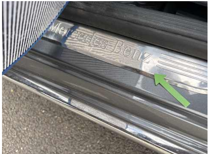
Fahrtür (Delle, Kratzer)
