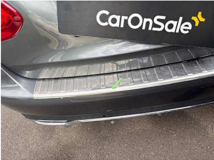
Stoßstange hinten (Riss/Bruch, Lackschaden)
