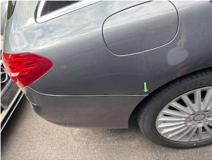
Stoßstange hinten (Spaltmaße ungenau)
