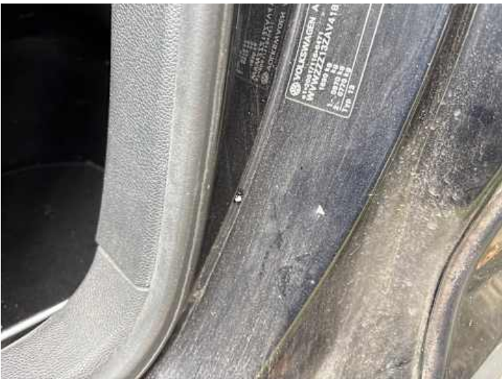
Schweller links (Kratzer, Delle)
