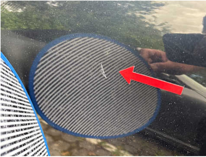
Seitenteil hinten rechts (Kratzer)
