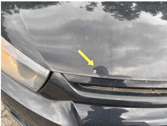
Motorhaube (Steinschlag, Rost)
