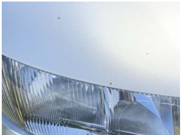
Motorhaube (Lackschaden, Rost)
