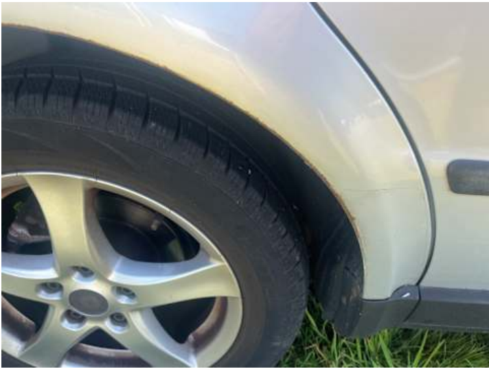
Seitenteil hinten rechts (Lackschaden, Rost)
