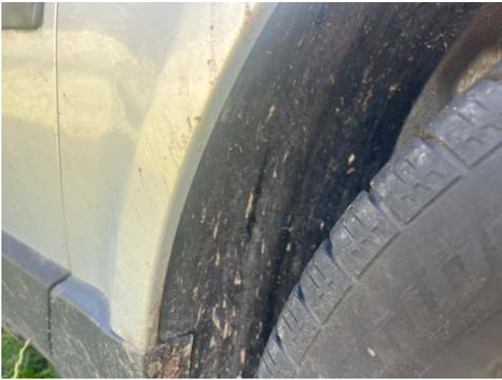
Kotflügel vorne rechts (Lackschaden, Rost)
