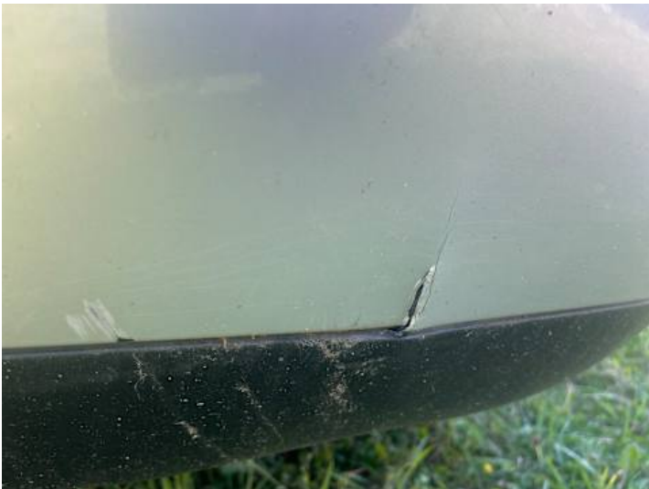
Stoßstange hinten (Riss/Bruch)
