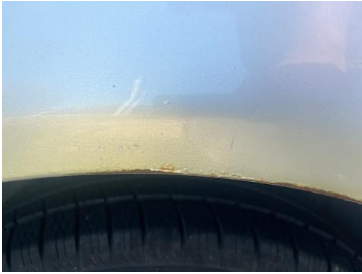
Seitenteil hinten rechts (Lackschaden, Rost)
