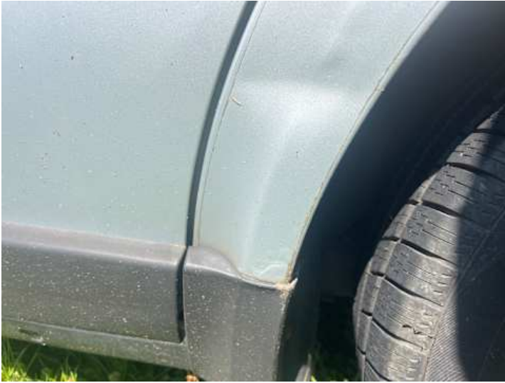
Seitenteil hinten links (Kratzer, Riss/Bruch)
