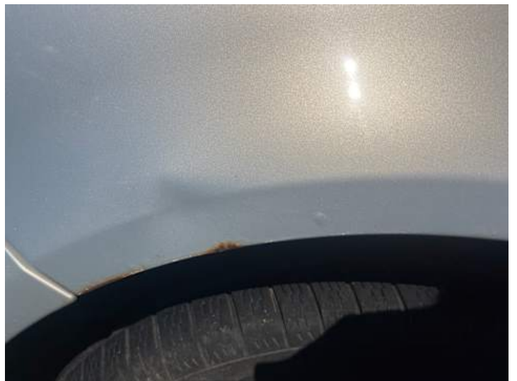
Kotflügel vorne links (Lackschaden, Rost)
