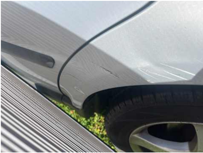
Seitenteil hinten links (Verformung)
