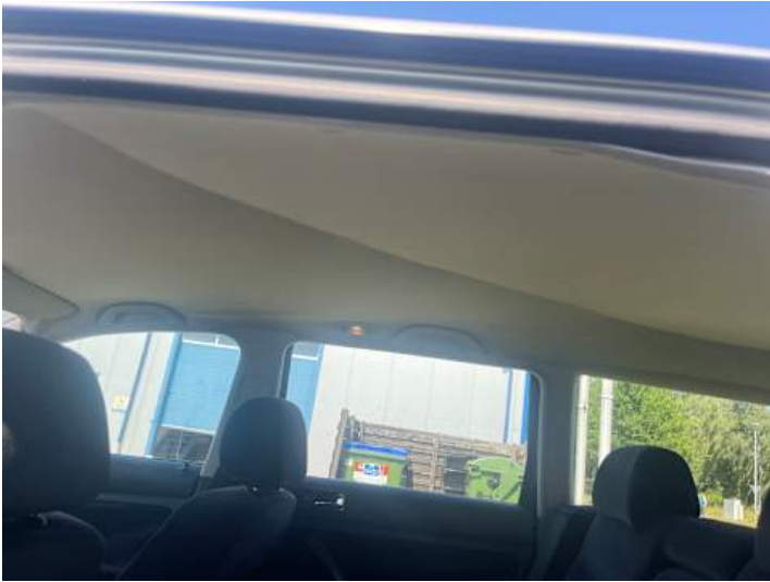
Innenraum (Anderer Schaden): Dachhimmel hängt
