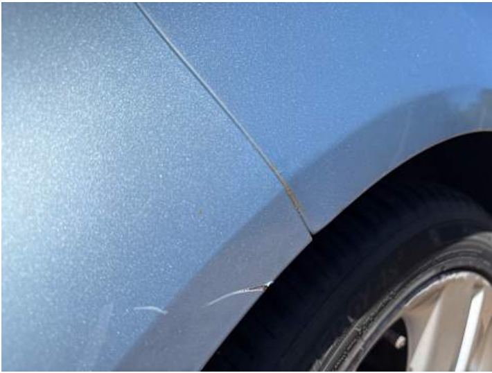
Seitenteil hinten rechts (Rost)
