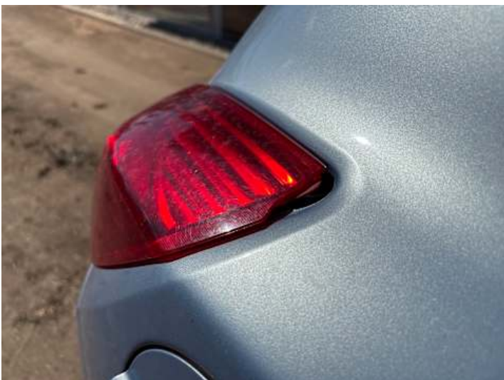
Rücklicht (links) (Riss/Bruch)
