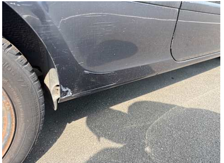
Schweller rechts (Kratzer)
