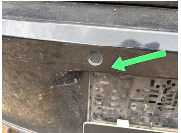
Stoßstange hinten (Anderer Schaden): Eingedrückt
