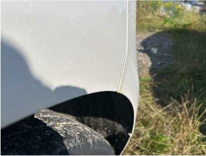
Stoßstange hinten (Kratzer, Lackschaden, Spaltmaße ungenau)
