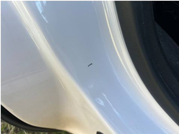
Türe hinten rechts (Kratzer, Lackschaden)
