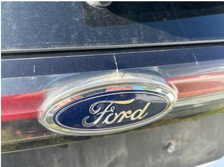
Rücklicht (links) (Undicht, Riss/Bruch)
