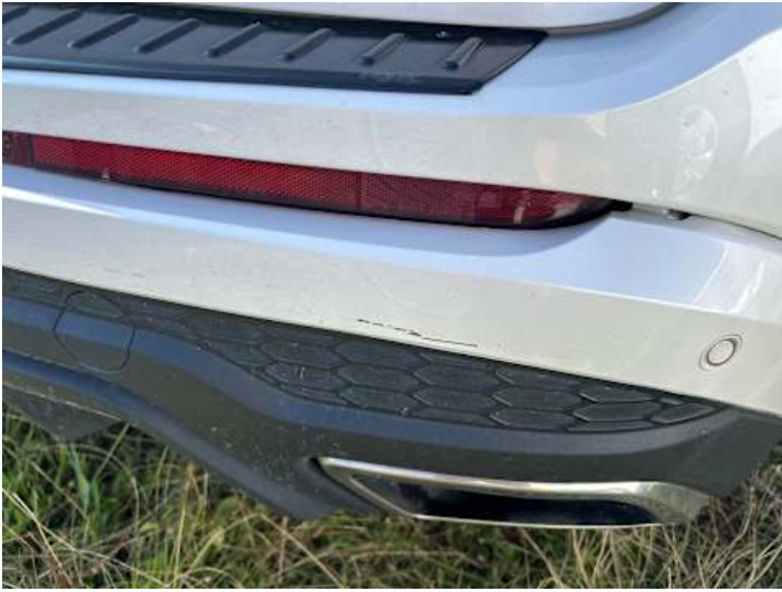
Stoßstange hinten (Kratzer, Lackschaden, Spaltmaße ungenau)
