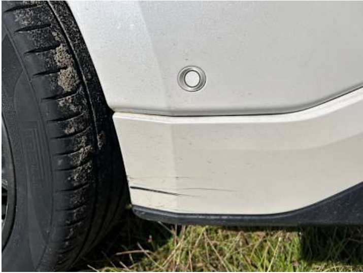
Stoßstange hinten (Kratzer, Lackschaden, Spaltmaße ungenau)
