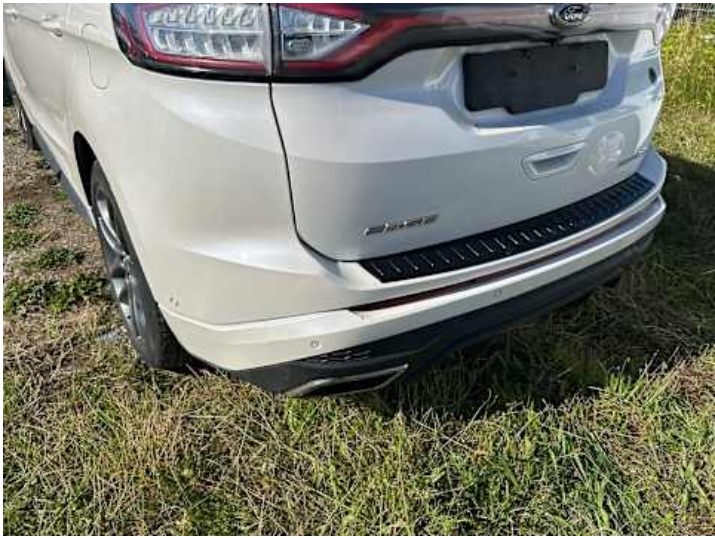
Stoßstange hinten (Kratzer, Lackschaden, Spaltmaße ungenau)
