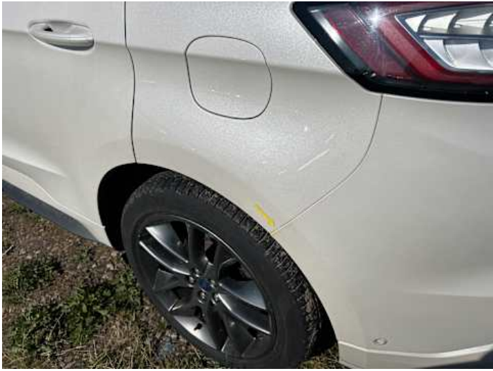
Seitenteil hinten links (Lackschaden)
