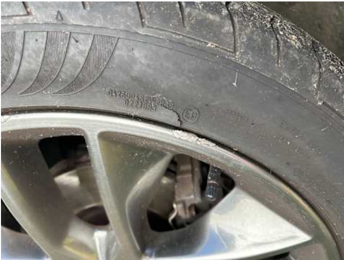
Rad (Kratzer, Riss/Bruch)
