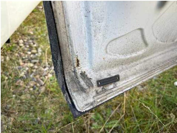
Türe hinten links (Lackschaden)
