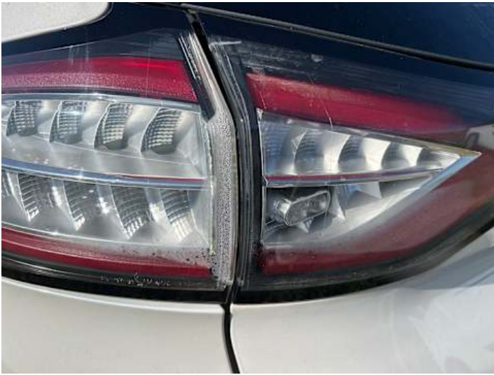
Rücklicht (links) (Undicht, Riss/Bruch)
