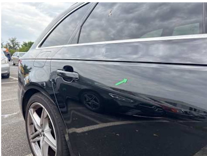
Türe hinten rechts (Delle, Verformung)
