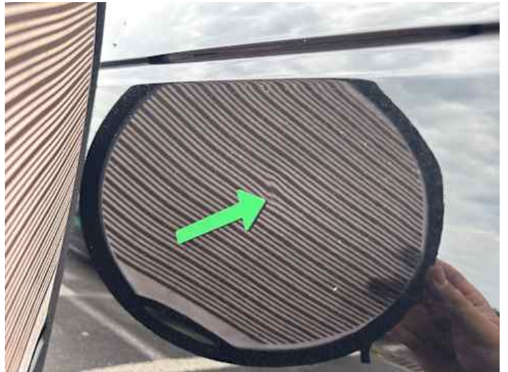
Türe hinten rechts (Delle, Verformung)
