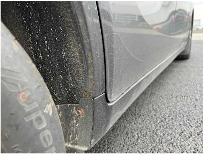
Seitenteil hinten rechts (Rost)
