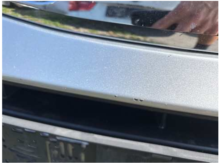
Stoßstange vorne (Kratzer, Spaltmaße ungenau)
