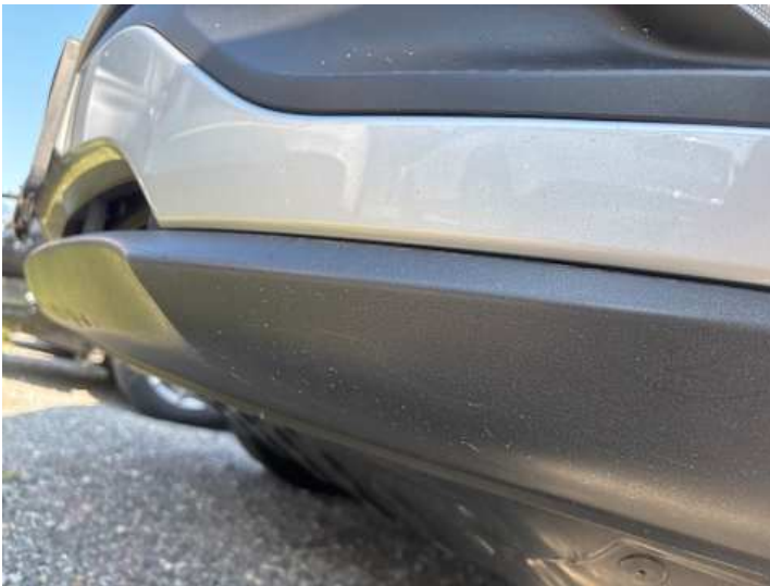
Stoßstange vorne (Kratzer, Spaltmaße ungenau)
