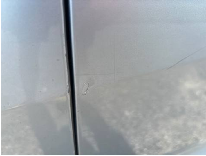
Türe hinten links (Lackschaden, Delle, Unsachgemäß instand gesetzt)
