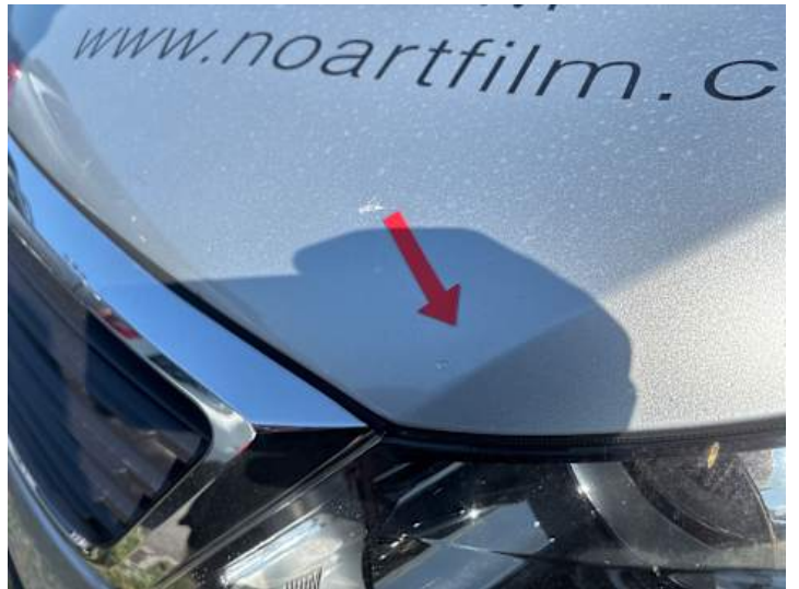
Motorhaube (Steinschlag, Unsachgemäß instand gesetzt)
