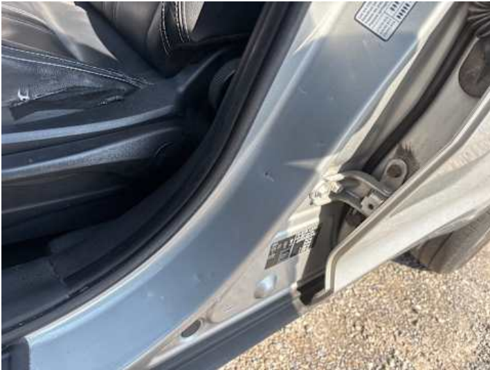
Schweller links (Lackschaden, Delle)
