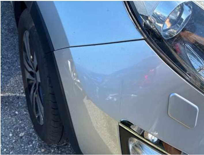
Stoßstange vorne (Kratzer, Spaltmaße ungenau)
