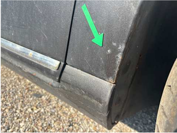
Kotflügel vorne rechts (Rost)
