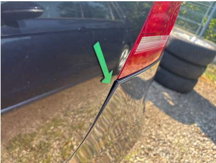
Stoßstange hinten (Spaltmaße ungenau)
