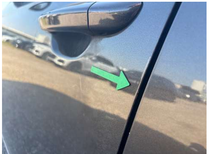
Fahrtür (Kratzer, Unsachgemäß instand gesetzt)
