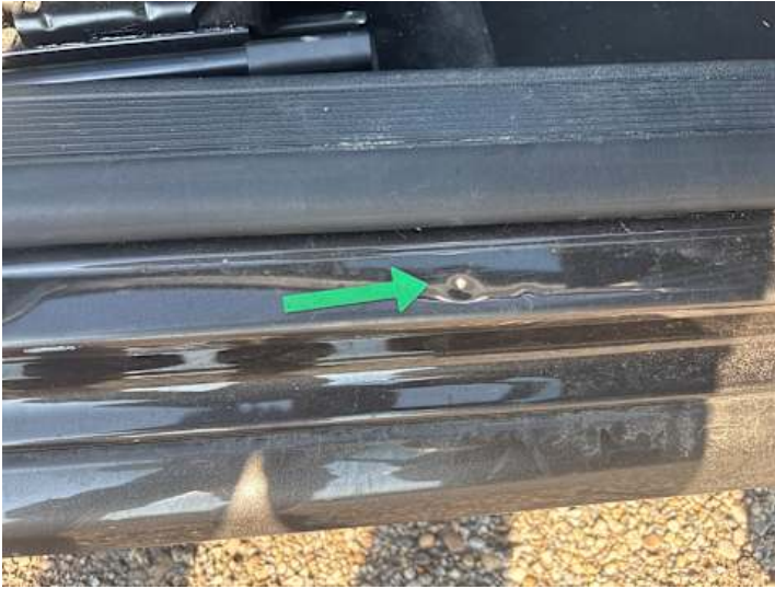
Schweller rechts (Delle)
