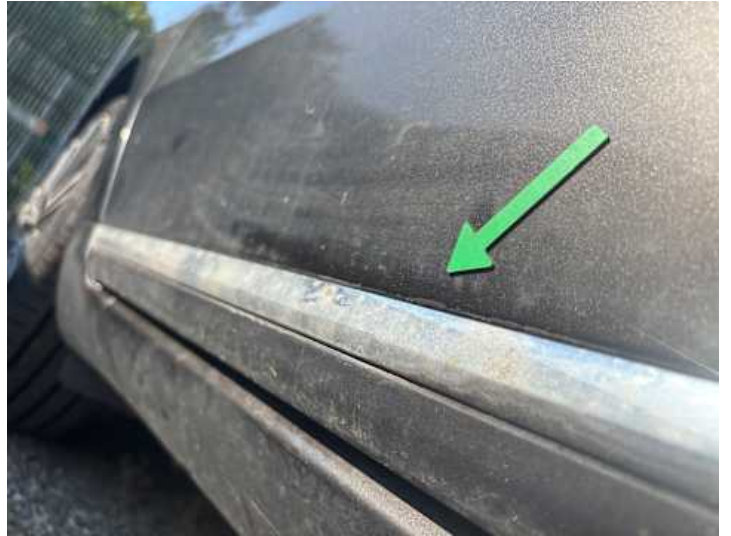
Türe hinten rechts (Rost)
