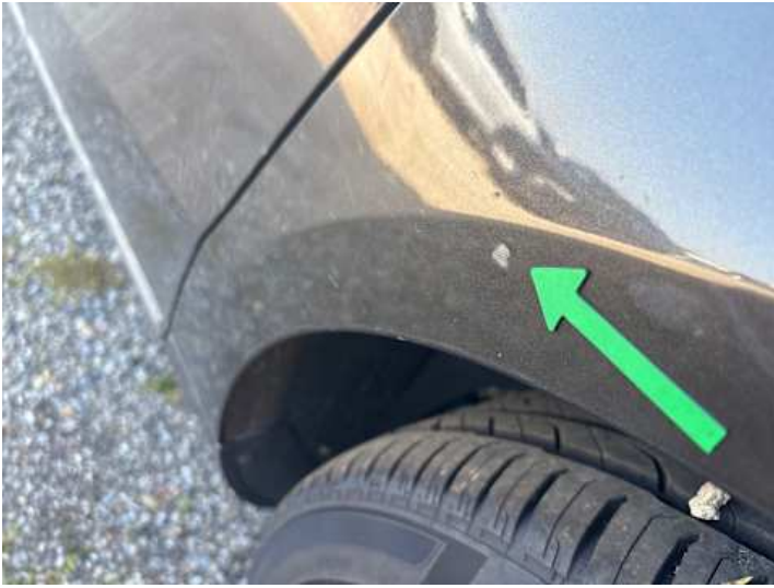
Seitenteil hinten links (Rost)
