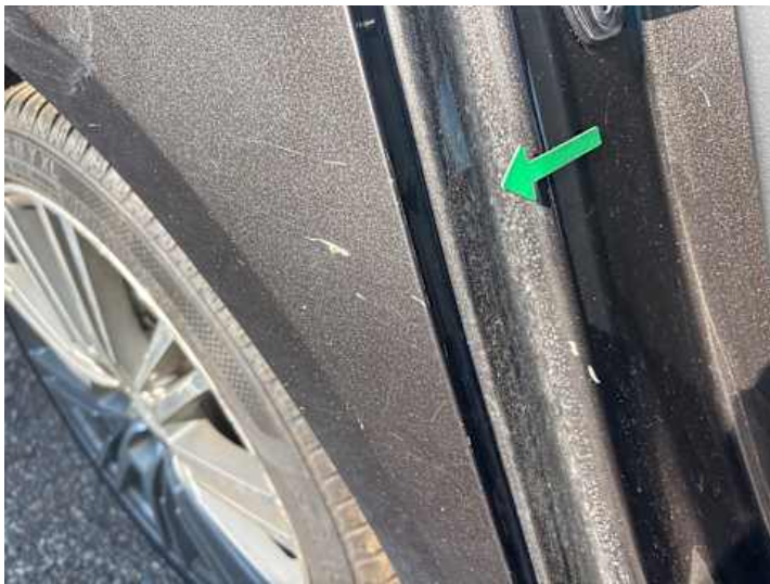
Seitenteil hinten rechts (Kratzer, Rost)
