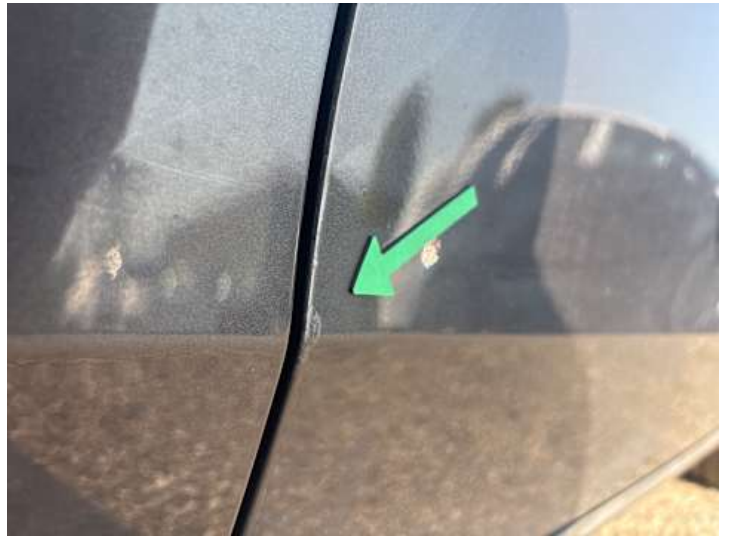
Beifahrertür (Kratzer, Lackschaden, Unsachgemäß instand gesetzt)
