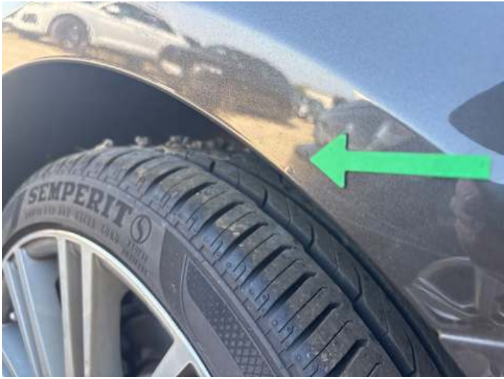
Seitenteil hinten links (Rost)
