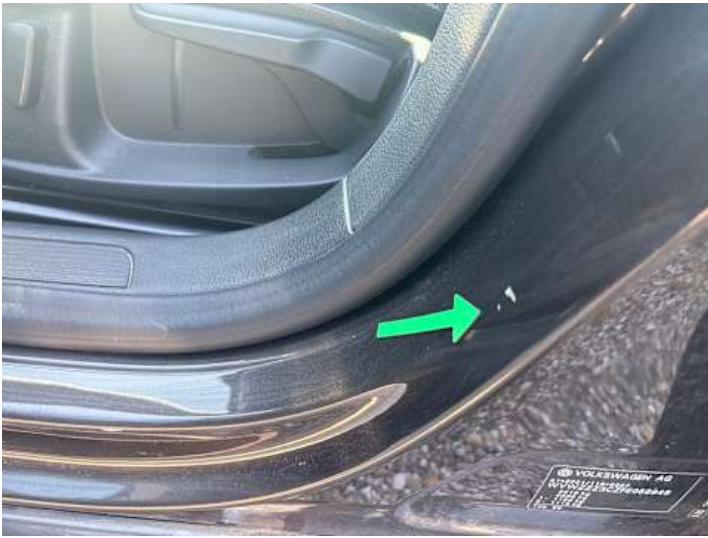
Schweller links (Kratzer, Delle)
