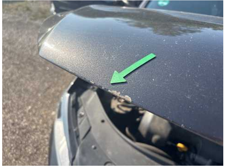
Motorhaube (Steinschlag, Kratzer, Unsachgemäß instand gesetzt, Lackschaden)
