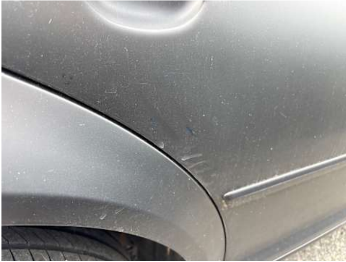
Türe hinten rechts (Kratzer, Lackschaden)
