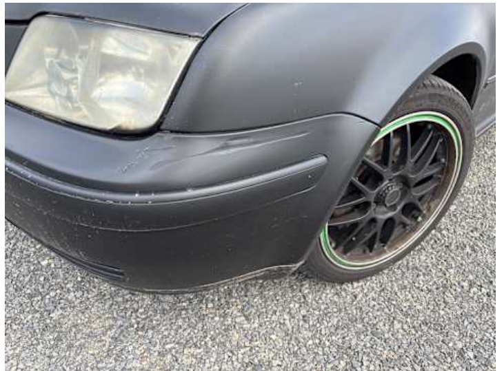
Stoßstange vorne (Kratzer, Verformung, Spaltmaße ungenau)
