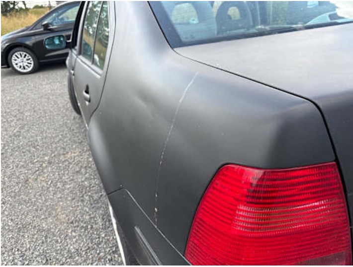
Seitenteil hinten links (Verformung)
