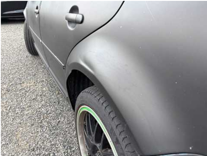
Seitenteil hinten links (Verformung)
