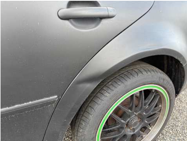
Seitenteil hinten links (Verformung)
