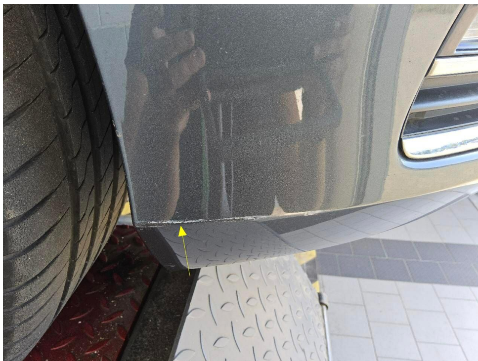
Bild 14 : Diverse Gebrauchsspuren, Kratzer, Dellen und Umweltbeaufschlagung rundum Stoßfänger vorne verschrammt
