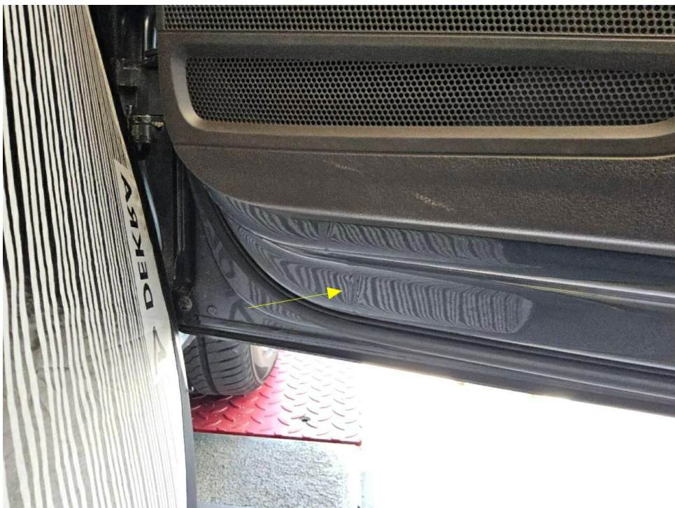
Bild 18 : Diverse Gebrauchsspuren, Kratzer, Dellen und Umweltbeaufschlagung rundum Tür vorne rechts, Innenbereich eingedellt
