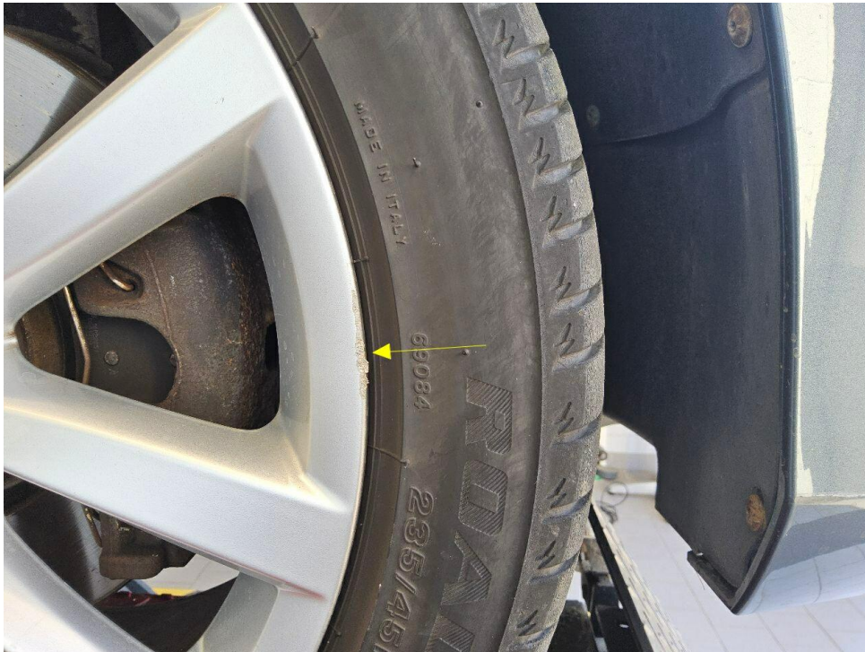
Bild 21 : Diverse Gebrauchsspuren, Kratzer, Dellen und Umweltbeaufschlagung rundum Felge hinten links verschrammt
