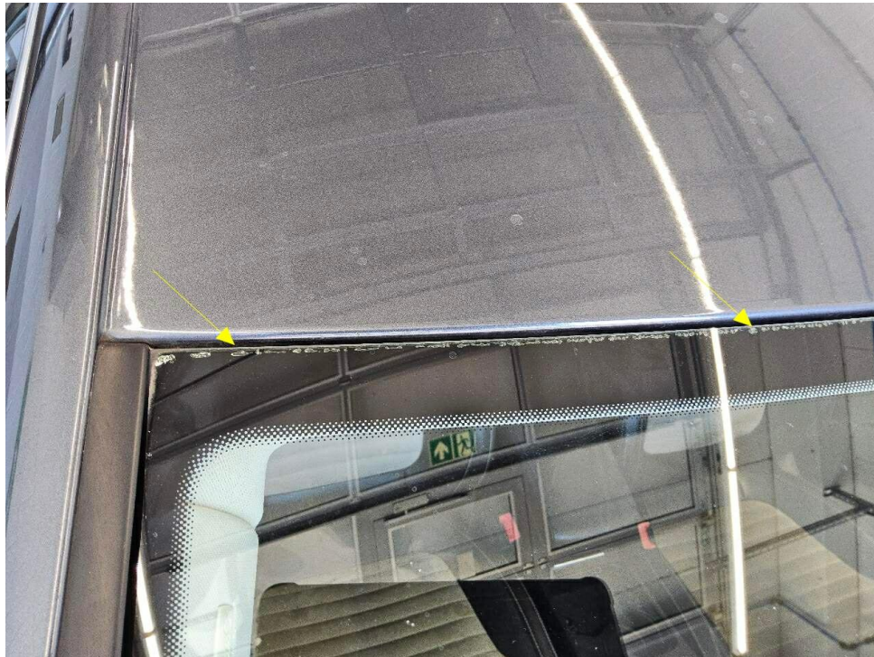
Bild 11 : Windschutzscheibe, Klebeverbindung löst sich im Randbereich
