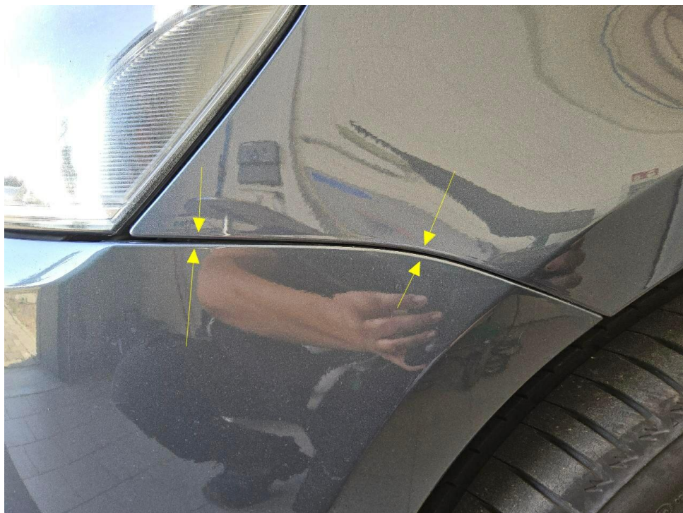
Bild 12 : Diverse Gebrauchsspuren, Kratzer, Dellen und Umweltbeaufschlagung rundum Stoßfänger vorne, Spaltmaß vorhanden
