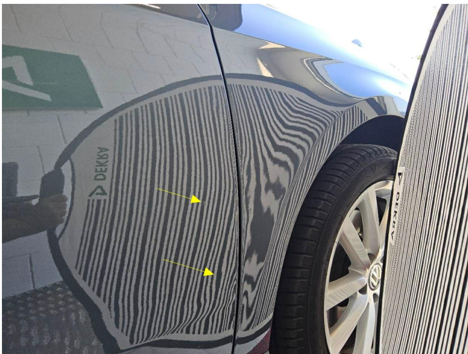
Bild 16 : Diverse Gebrauchsspuren, Kratzer, Dellen und Umweltbeaufschlagung rundum Tür vorne rechts leicht eingedellt
