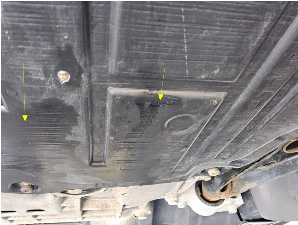
Bild 25 : ungeklärter Flüssigkeitsverlust, prüfen und nach Befund instandsetzen. Kostenerweiterung möglich!
