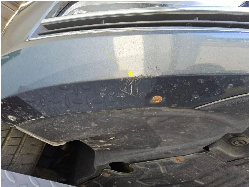
Bild 15 : Diverse Gebrauchsspuren, Kratzer, Dellen und Umweltbeaufschlagung rundum Stoßfänger vorne verschrammt
