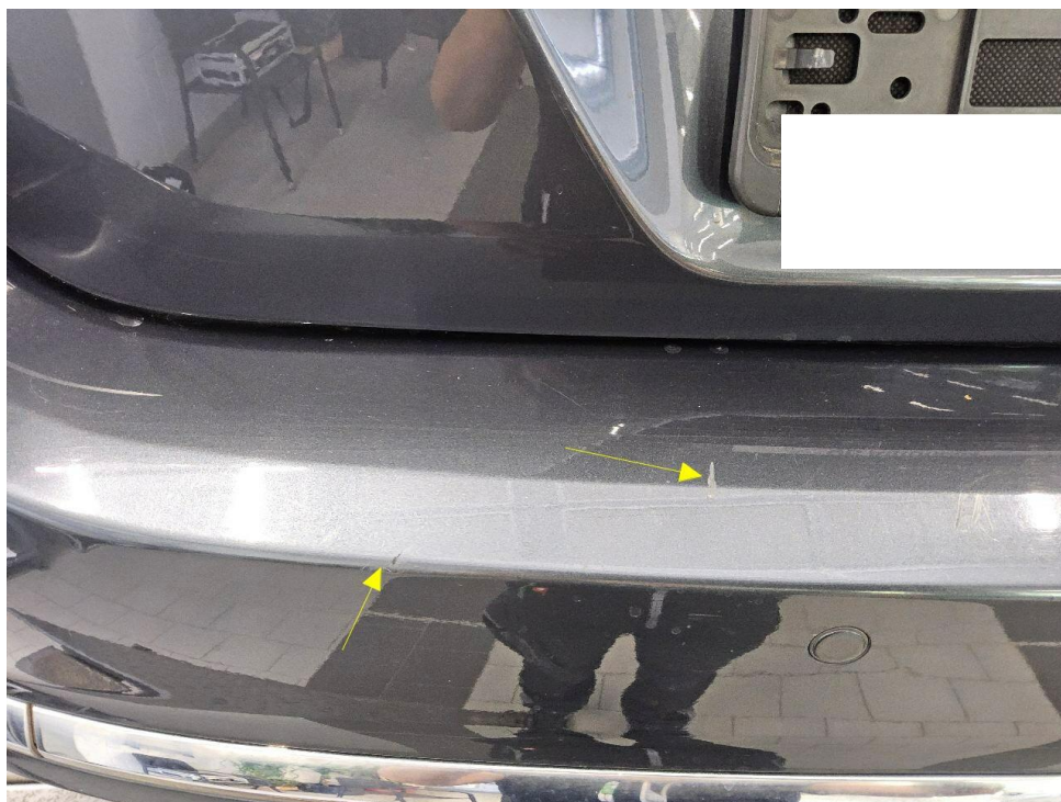
Bild 20 : Diverse Gebrauchsspuren, Kratzer, Dellen und Umweltbeaufschlagung rundum Stoßfänger hinten, verschrammt
