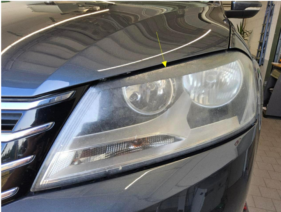
Bild 23 : Hauptscheinwerfer links und rechts, Streuscheibe matt
