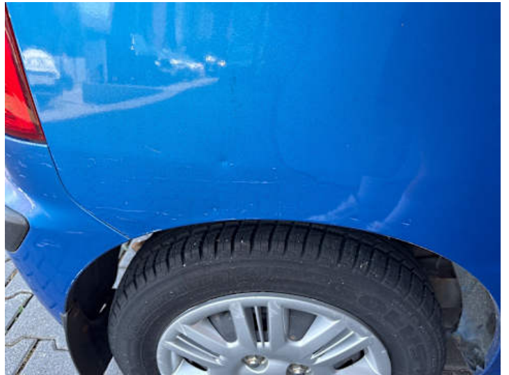
Seitenteil hinten rechts (Delle, Kratzer, Lackschaden, Ausgeblichen/Matt)
