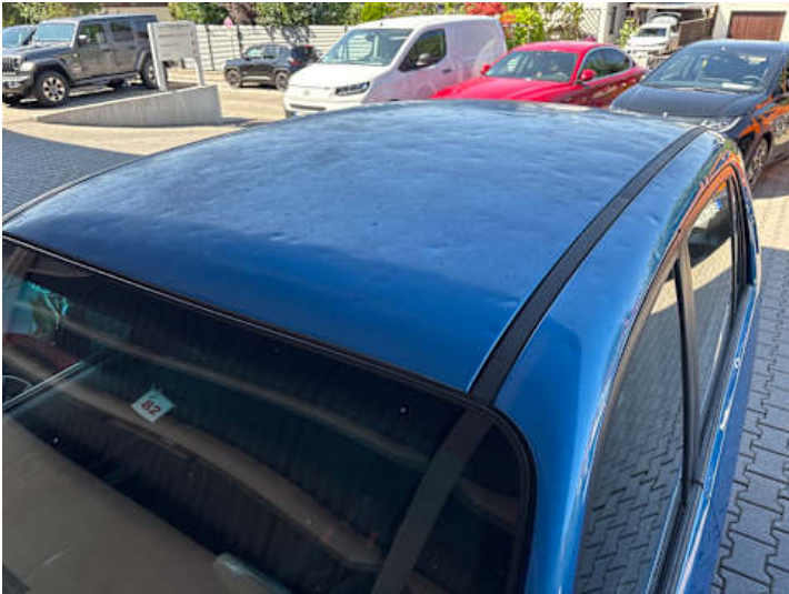
Dach (Delle, Ausgeblichen/Matt, Lackschaden)
