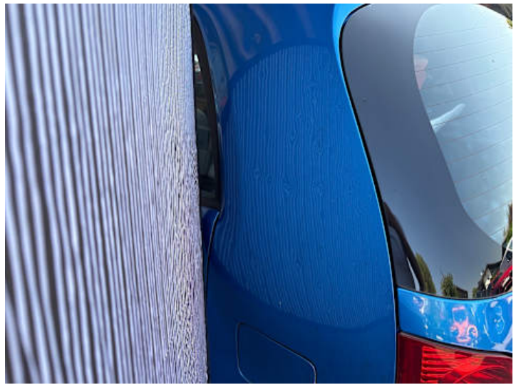
Seitenteil hinten links (Delle, Lackschaden, Ausgeblichen/Matt)
