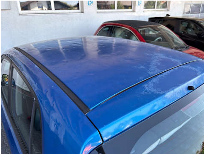
Dach (Delle, Ausgeblichen/Matt, Lackschaden)
