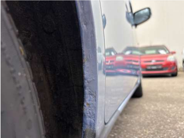
Seitenteil hinten rechts (Rost)
