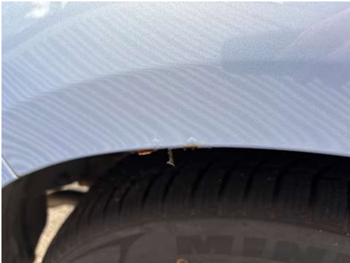
Seitenteil hinten rechts (Rost)
