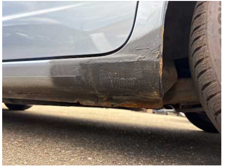
Schweller links (Rost)
