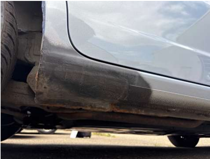
Schweller rechts (Rost, Lackschaden)
