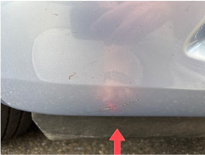
Stoßstange vorne (Kratzer, Unsachgemäß instand gesetzt)
