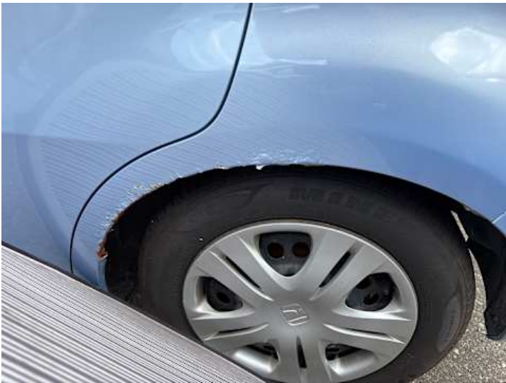
Seitenteil hinten links (Rost)
