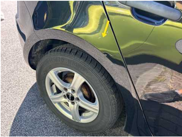
Seitenteil hinten rechts (Kratzer, Verformung, Unsachgemäß instand gesetzt)
