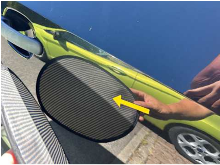
Türe hinten rechts (Verformung, Delle)
