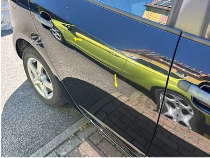
Türe hinten rechts (Verformung, Delle)
