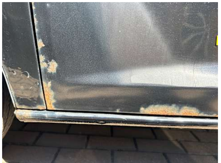
Fahrtür (Unsachgemäß instand gesetzt, Rost)
