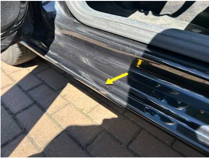
Schweller links (Kratzer, Rost, Unsachgemäß instand gesetzt)
