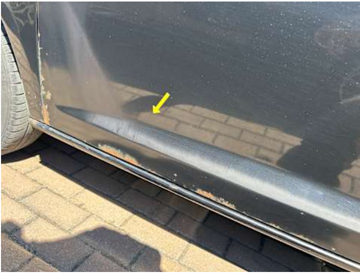
Fahrtür (Unsachgemäß instand gesetzt, Rost)
