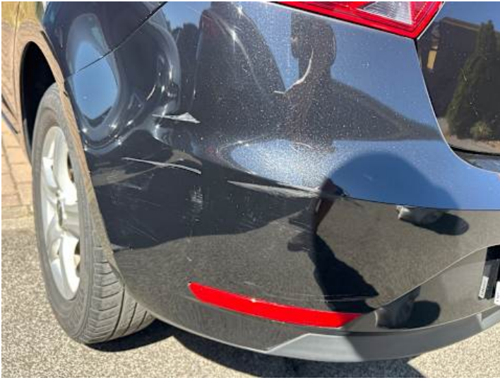
Stoßstange hinten (Kratzer, Verformung)
