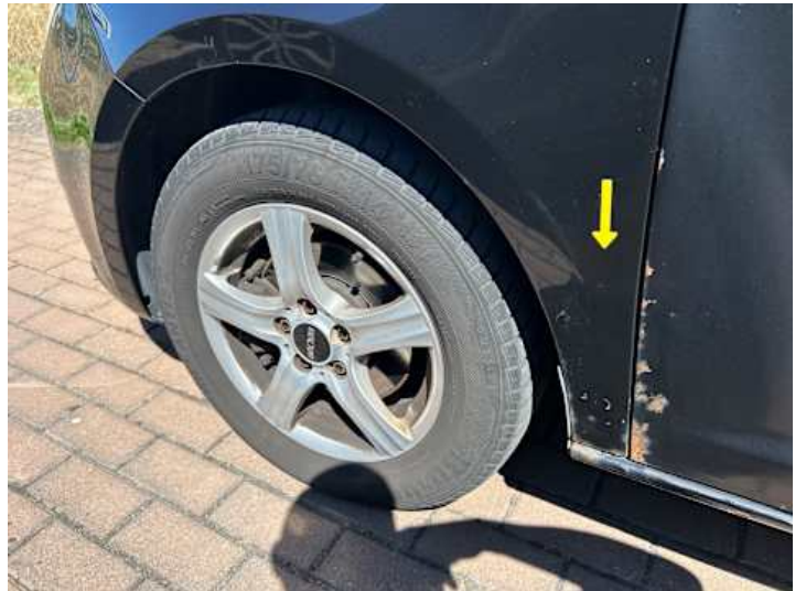
Kotflügel vorne links (Rost, Unsachgemäß instand gesetzt)
