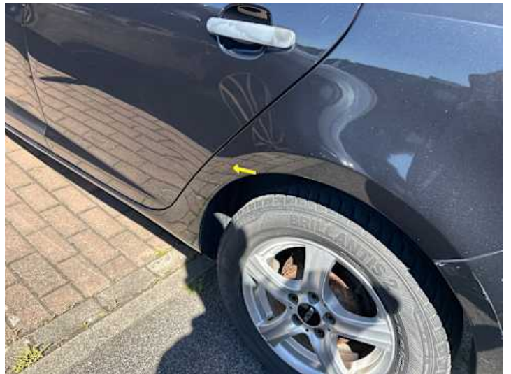
Seitenteil hinten links (Delle)
