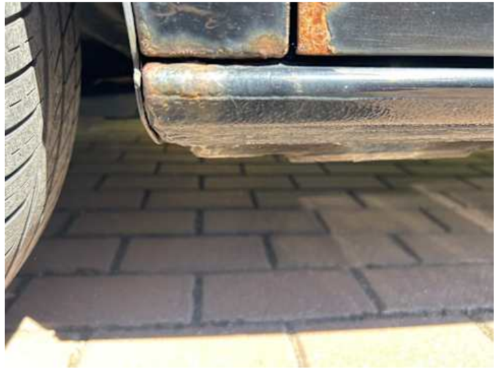
Schweller links (Rost)
