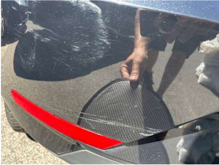
Stoßstange hinten (Kratzer, Verformung)
