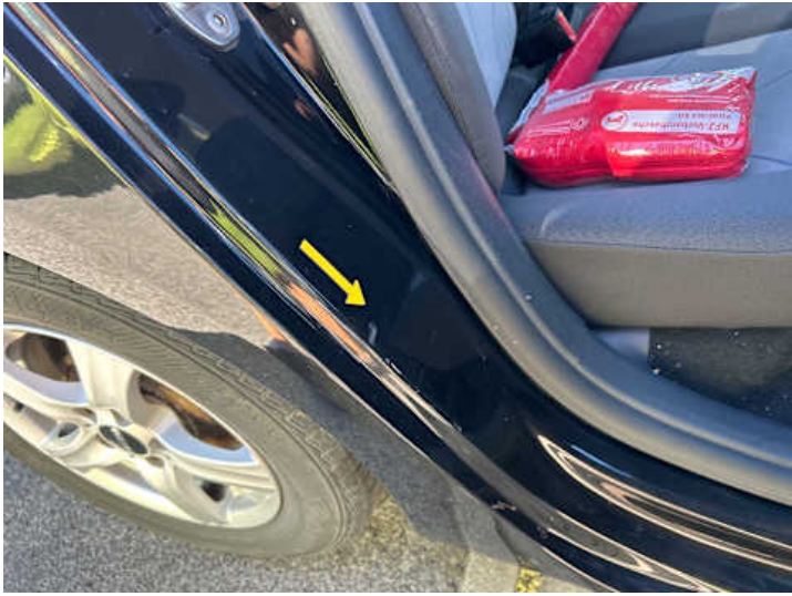
Türe hinten rechts (Delle, Kratzer)
