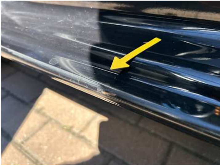
Schweller links (Kratzer, Rost, Unsachgemäß instand gesetzt)
