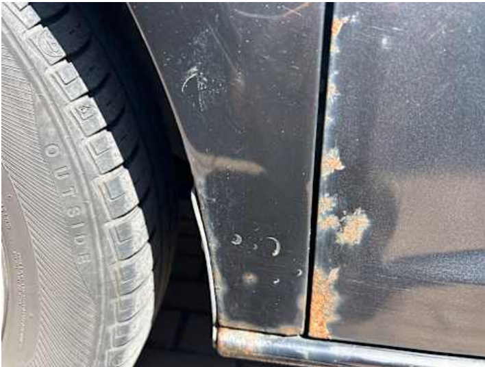
Kotflügel vorne links (Rost, Unsachgemäß instand gesetzt)
