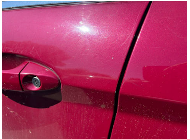
Fahrtür (Lackschaden, Kratzer)
