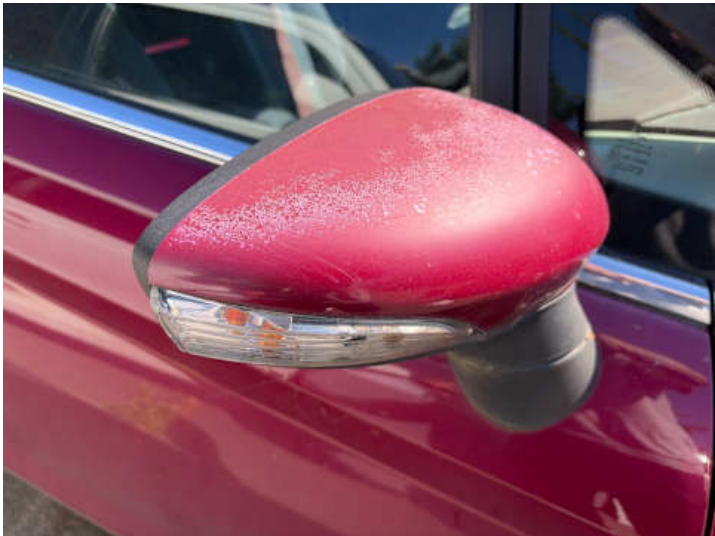
Beifahrertür (Lackschaden, Kratzer)
