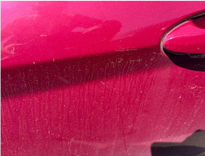
Fahrtür (Lackschaden, Kratzer)
