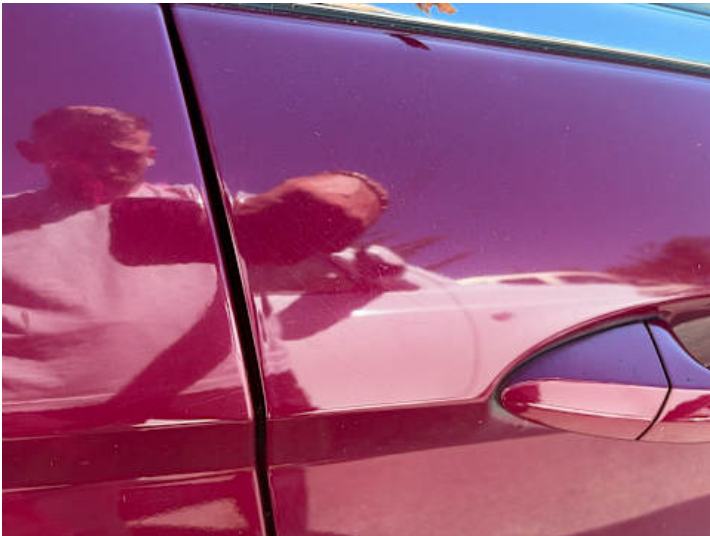
Beifahrertür (Lackschaden, Kratzer)
