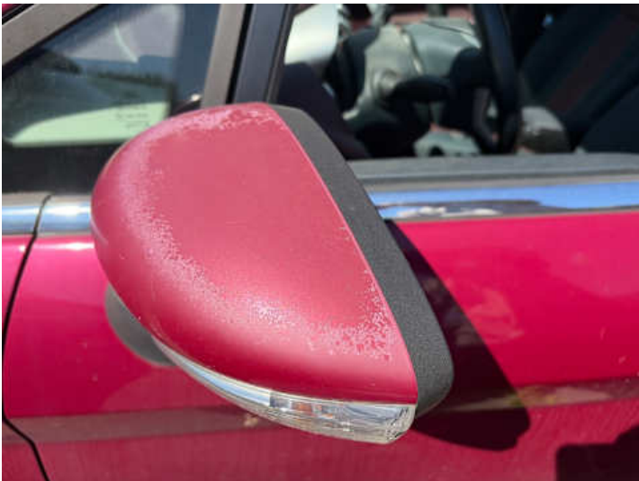
Fahrtür (Lackschaden, Kratzer)
