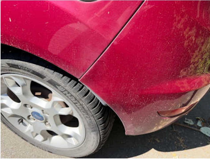
Stoßstange hinten (Spaltmaße ungenau)
