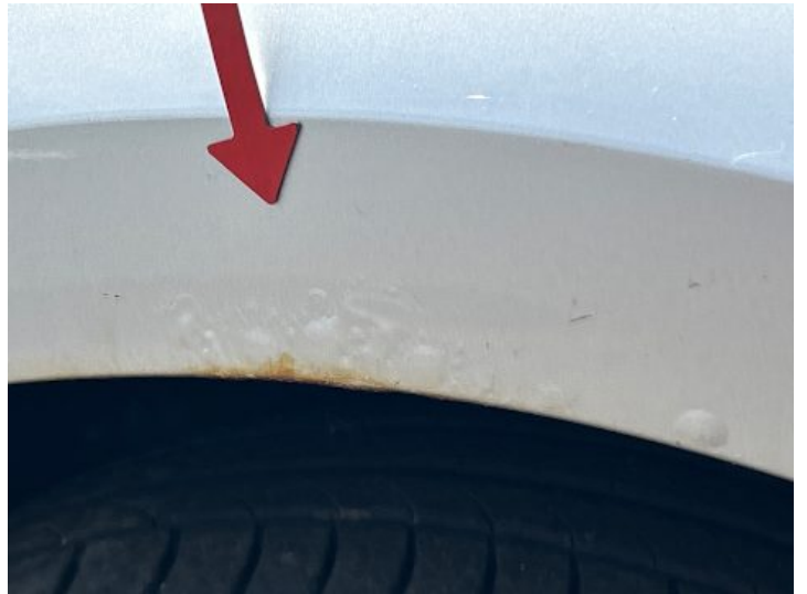
Kotflügel vorne links (Rost, Kratzer)
