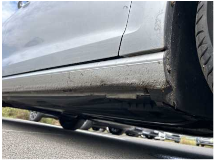
Schweller rechts (Verformung, Rost)
