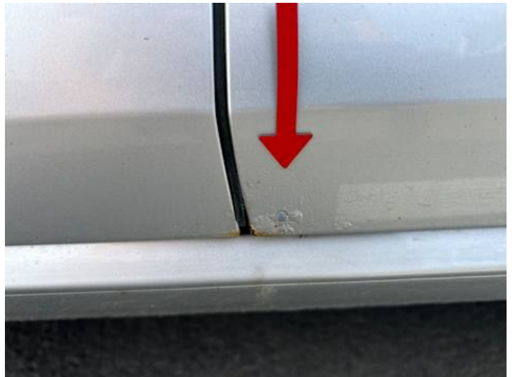
Türe hinten links (Rost)
