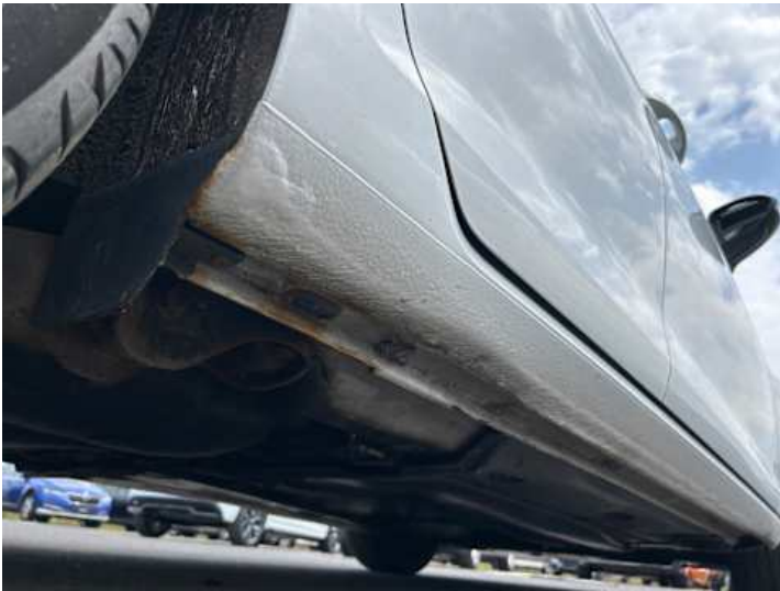
Schweller rechts (Verformung, Rost)
