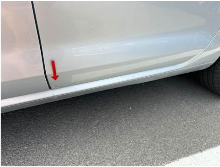
Türe hinten links (Rost)
