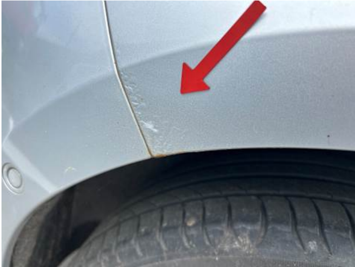
Seitenteil hinten rechts (Rost)
