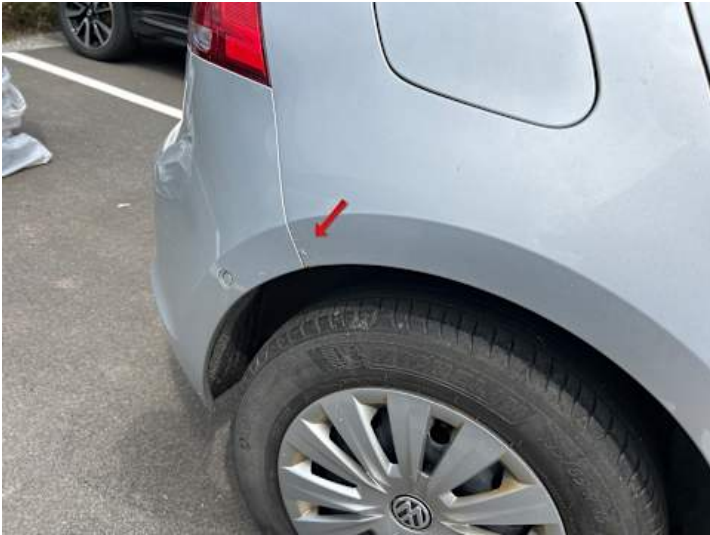
Seitenteil hinten rechts (Rost)
