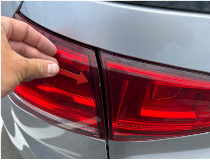
Rücklicht (links) (Riss/Bruch)
