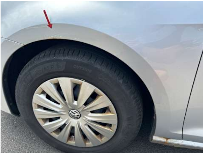
Kotflügel vorne links (Rost, Kratzer)
