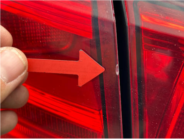
Rücklicht (links) (Riss/Bruch)
