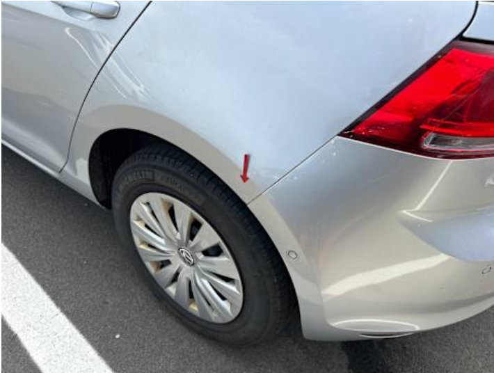
Seitenteil hinten links (Rost)
