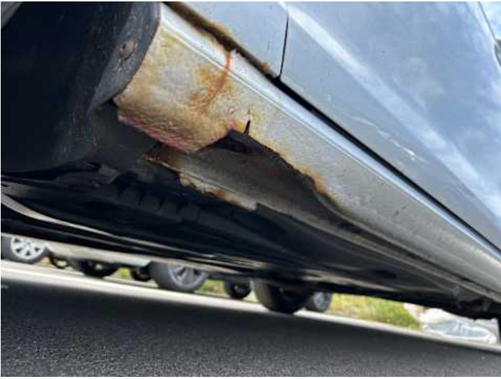
Schweller links (Verformung, Rost)
