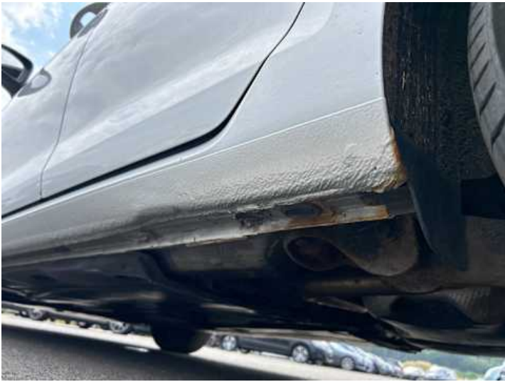
Schweller links (Verformung, Rost)
