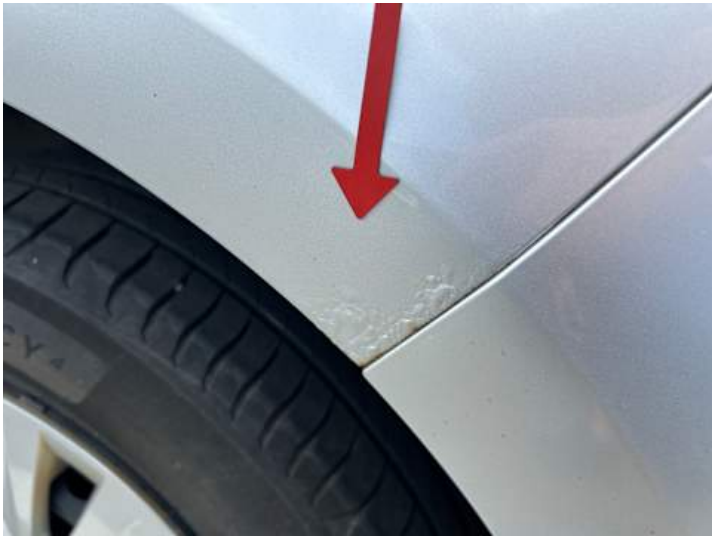
Seitenteil hinten links (Rost)
