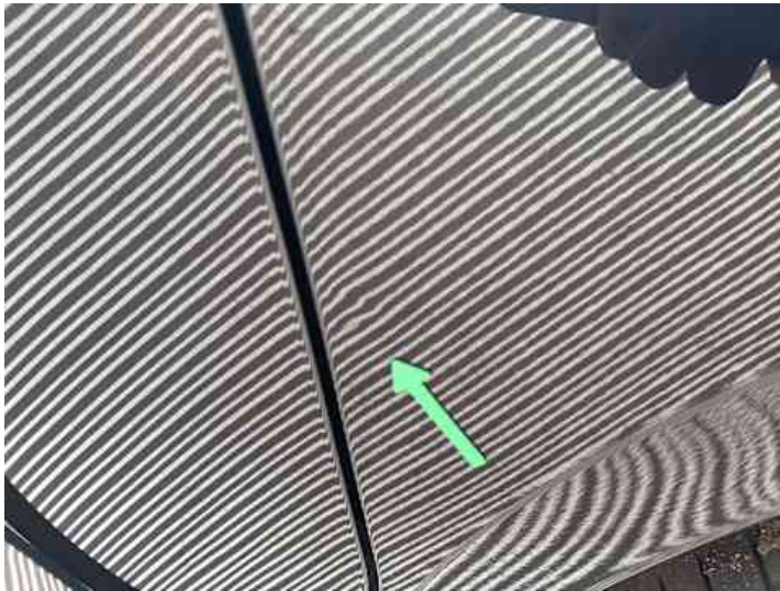
Seitenteil hinten links (Kratzer, Delle)
