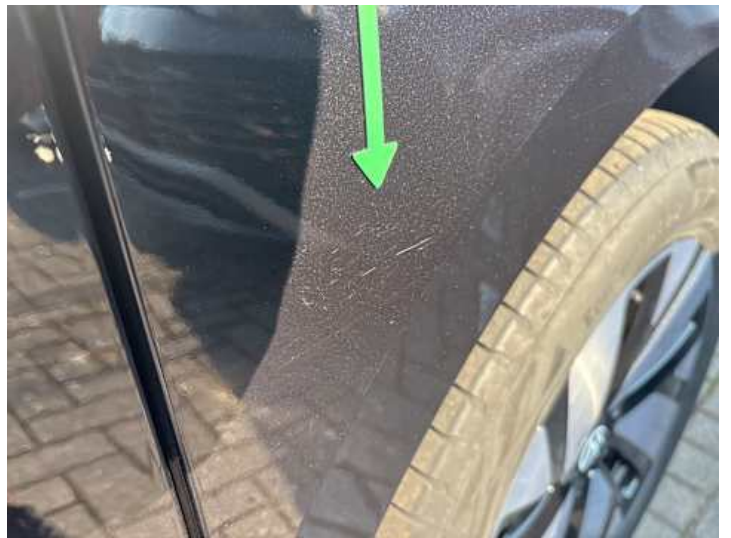
Seitenteil hinten links (Kratzer, Delle)
