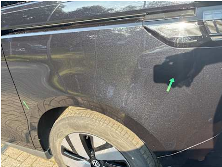
Seitenteil hinten links (Kratzer, Delle)
