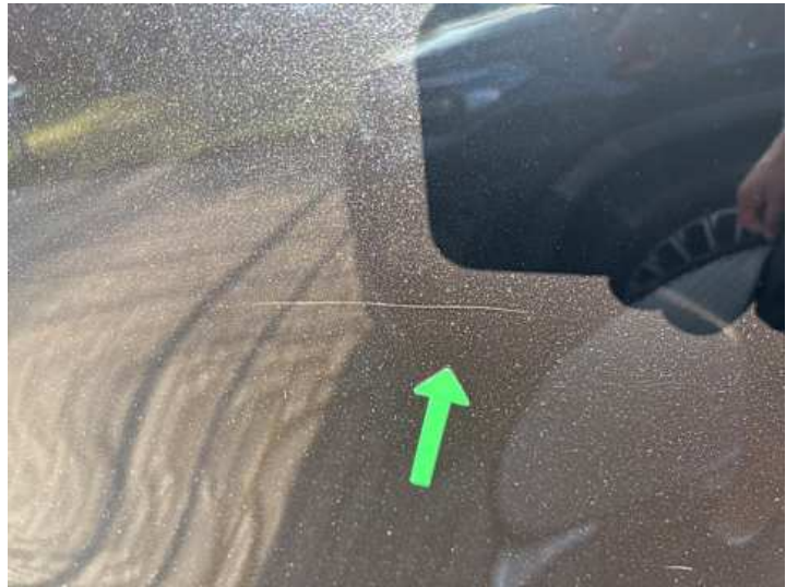
Seitenteil hinten links (Kratzer, Delle)
