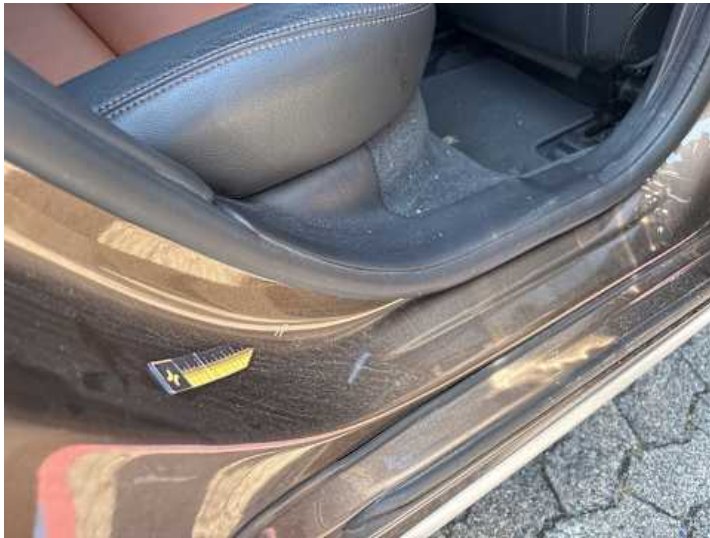
Schweller rechts (Kratzer)
