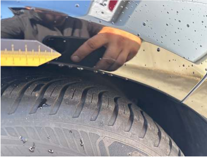
Kotflügel vorne rechts (Kratzer, Lackschaden)
