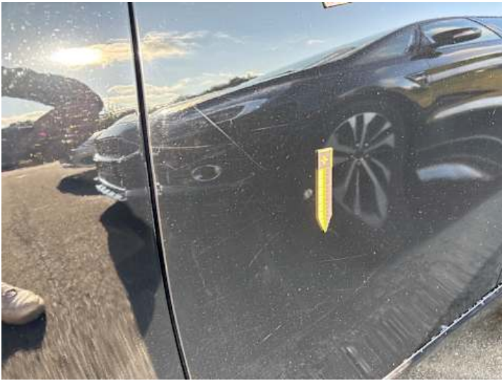
Türe hinten links (Kratzer)
