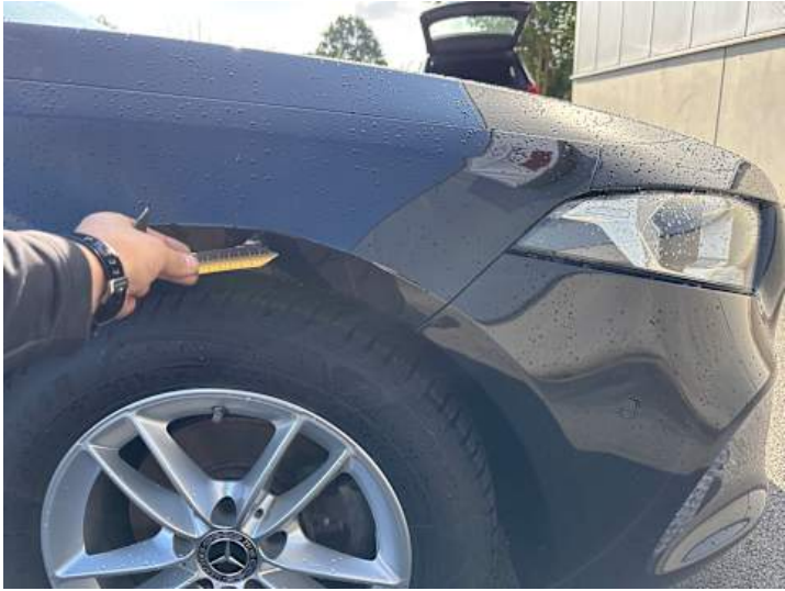
Kotflügel vorne rechts (Kratzer, Lackschaden)
