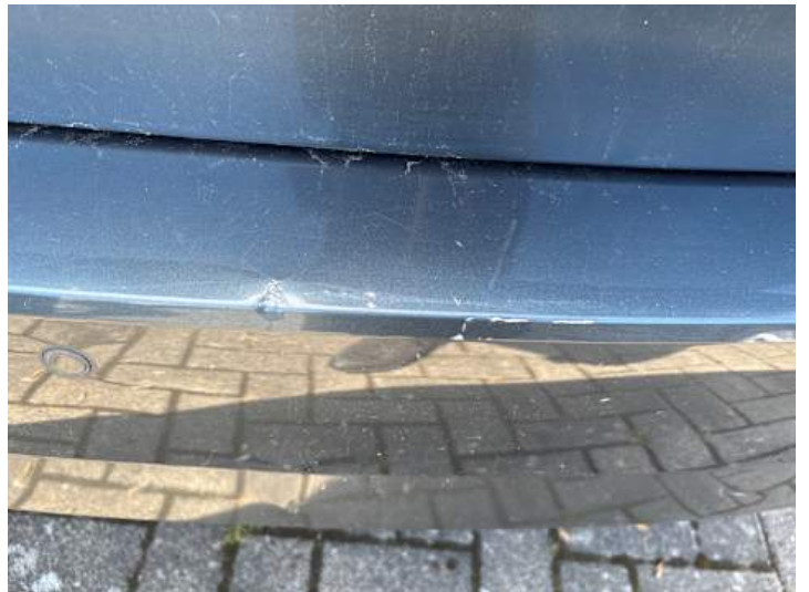
Stoßstange hinten (Kratzer, Verformung, Riss/Bruch, Unsachgemäß instand gesetzt)
