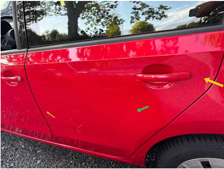
Türe hinten links (Kratzer, Delle)
