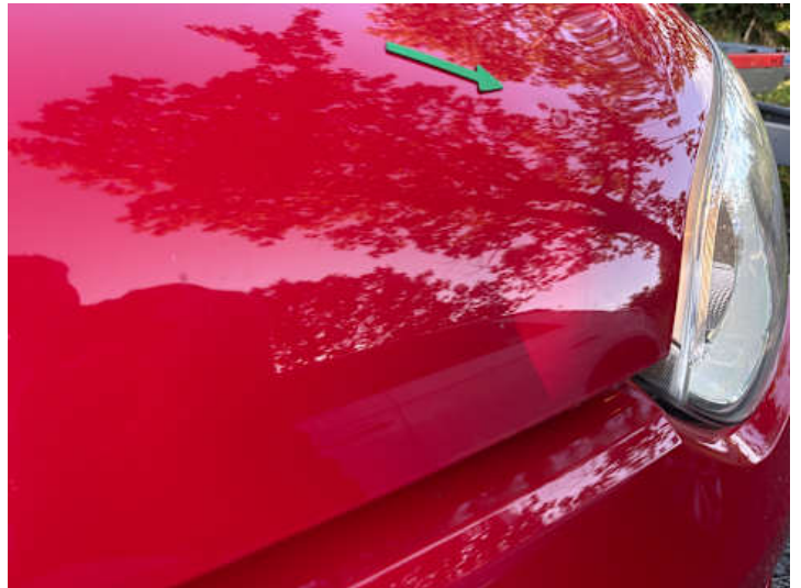
Motorhaube (Delle, Steinschlag)
