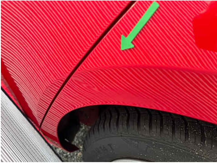
Seitenteil hinten links (Delle, Verformung)
