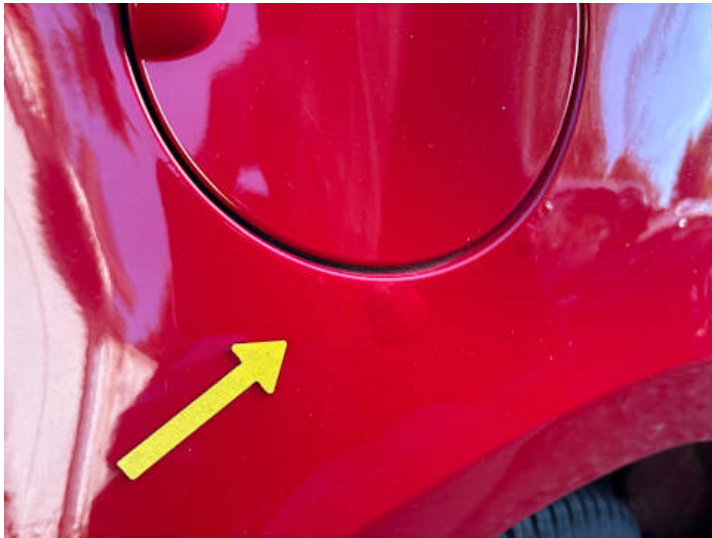
Seitenteil hinten rechts (Lackschaden, Delle)
