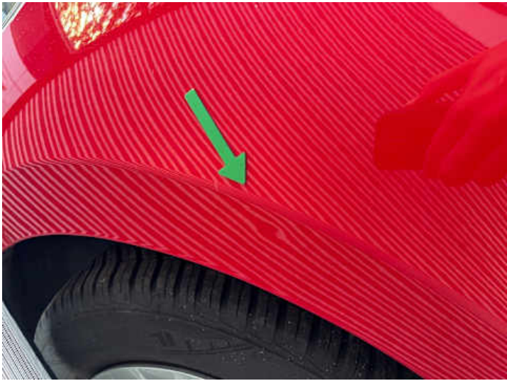
Kotflügel vorne links (Delle)
