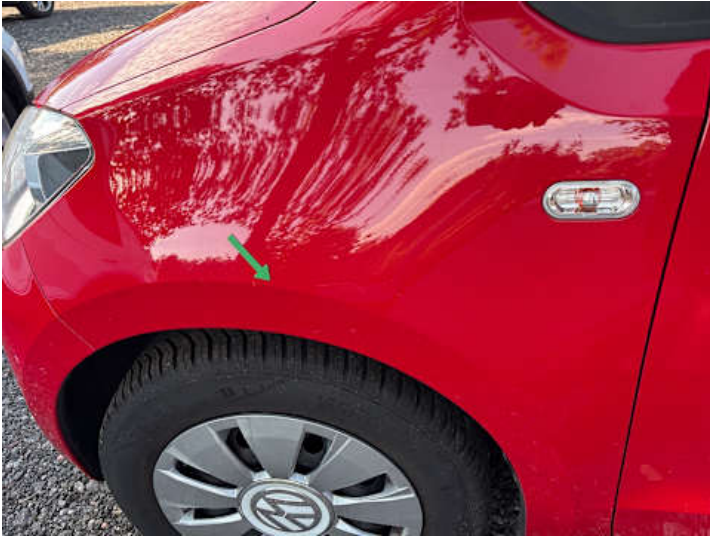
Kotflügel vorne links (Delle)
