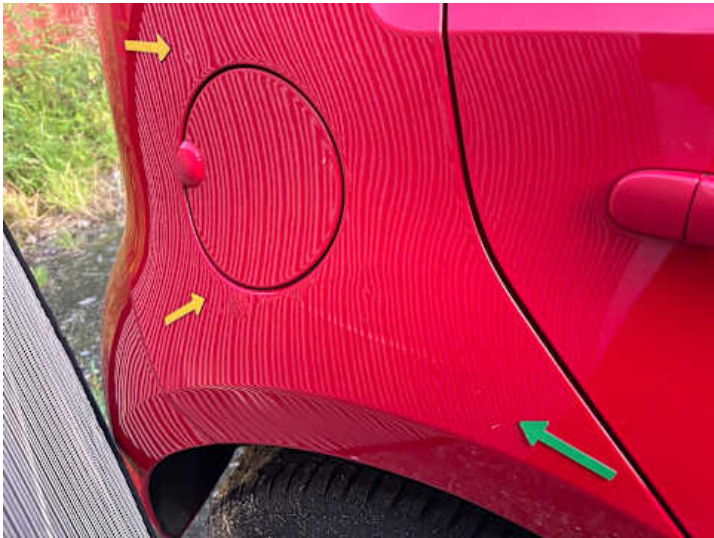
Seitenteil hinten rechts (Lackschaden, Delle)
