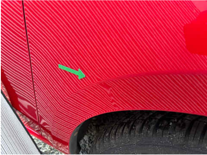
Kotflügel vorne rechts (Verformung)
