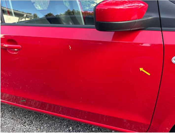
Beifahrertür (Kratzer, Delle)
