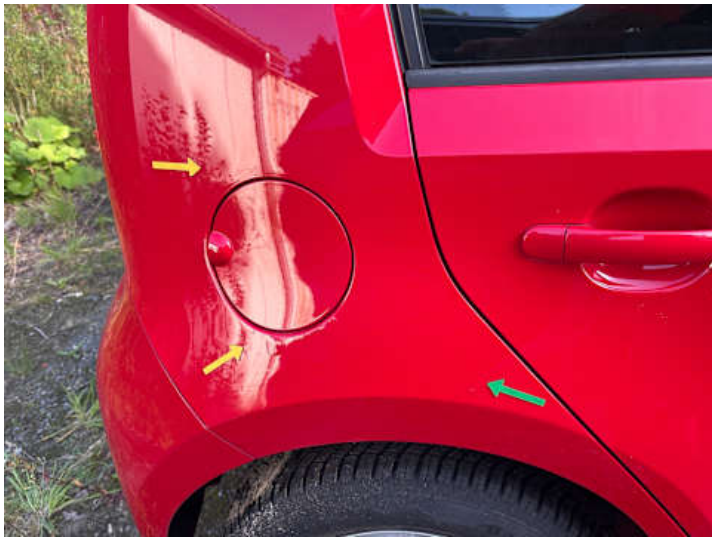
Seitenteil hinten rechts (Lackschaden, Delle)
