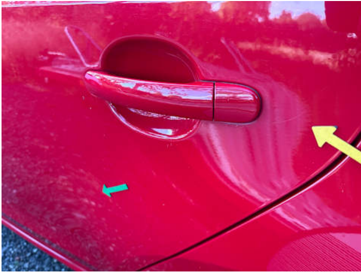
Türe hinten links (Kratzer, Delle)
