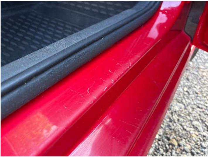
Schweller rechts (Kratzer)
