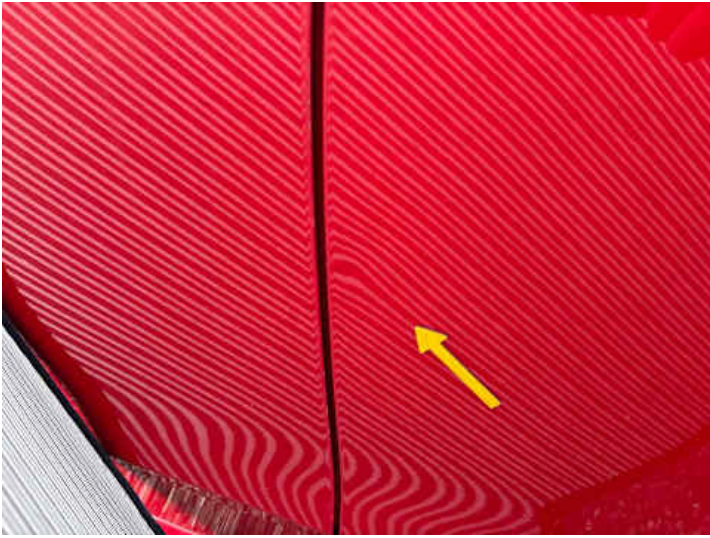
Türe hinten links (Kratzer, Delle)
