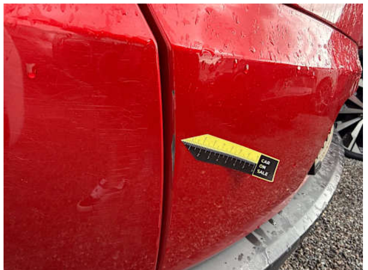
Heckklappe (Kratzer, Lackschaden)
