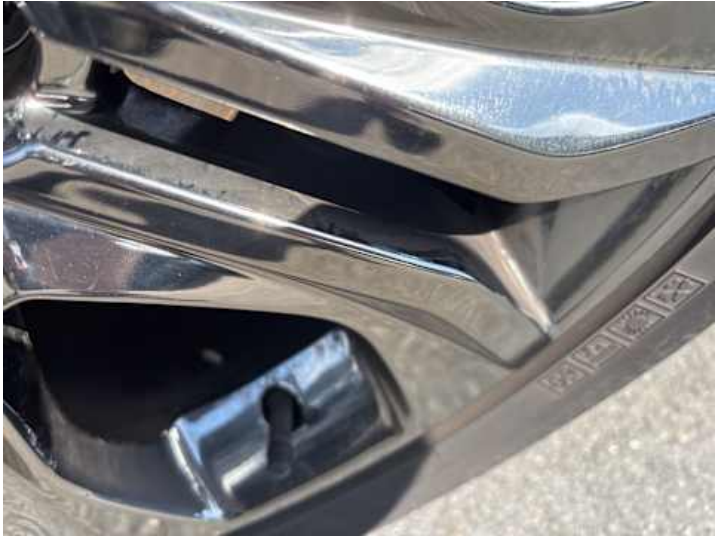
Rad (Anderer Schaden): Lack löst sich
