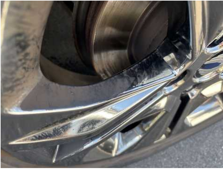
Rad (Anderer Schaden): Lack löst sich
