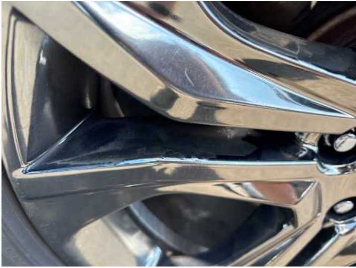
Rad (Anderer Schaden): Lack löst sich
