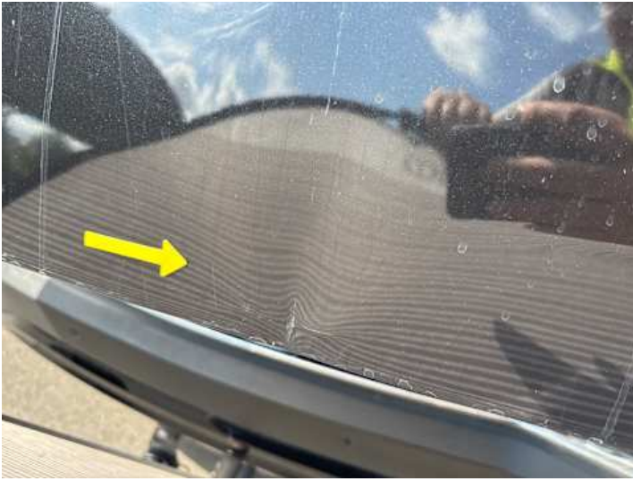
Heckklappe (Delle, Lackschaden)
