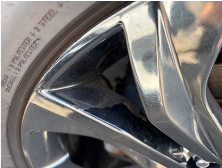
Rad (Anderer Schaden): Lack löst sich
