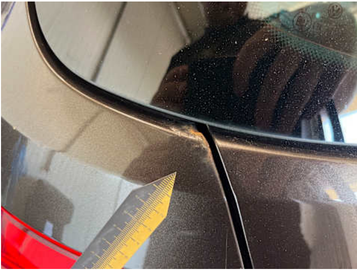
Seitenteil hinten links (Lackschaden, Rost)
