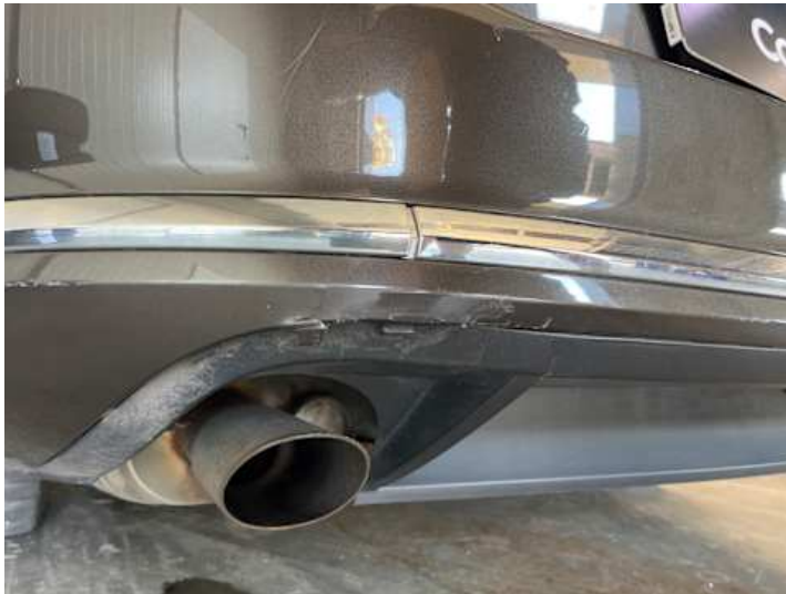
Stoßstange hinten (Kratzer, Lackschaden, Riss/Bruch)
