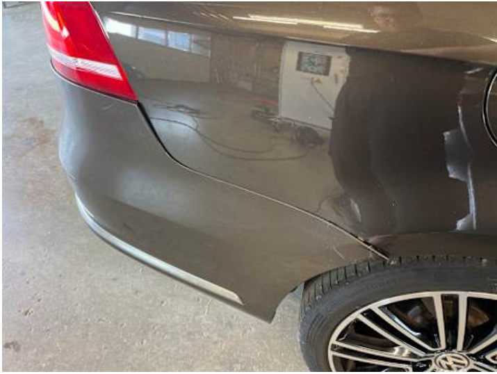
Stoßstange hinten (Kratzer, Lackschaden, Spaltmaße ungenau)
