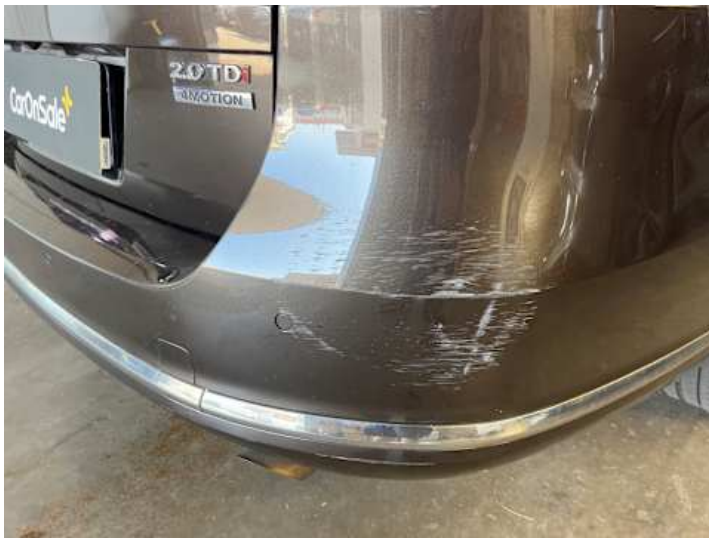
Stoßstange hinten (Kratzer, Lackschaden, Spaltmaße ungenau)
