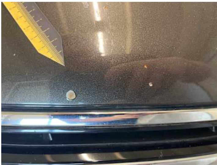
Motorhaube (Lackschaden, Rost, Steinschlag)
