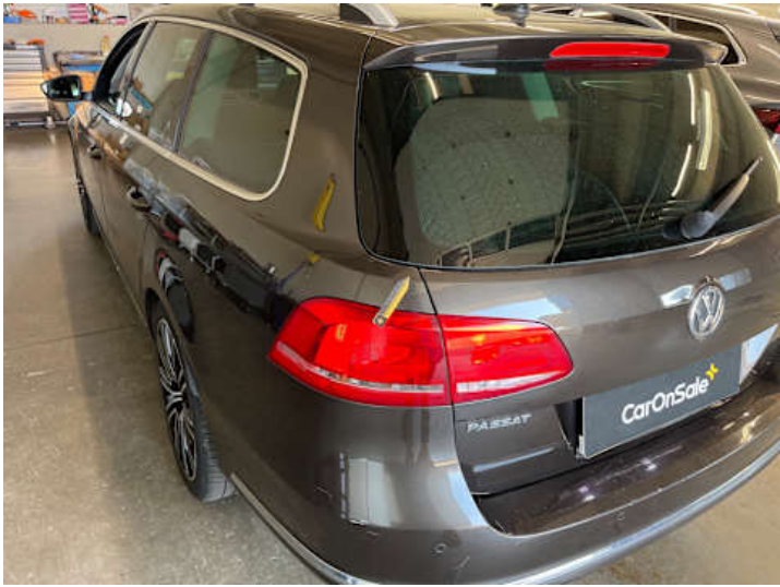
Seitenteil hinten links (Lackschaden, Rost)
