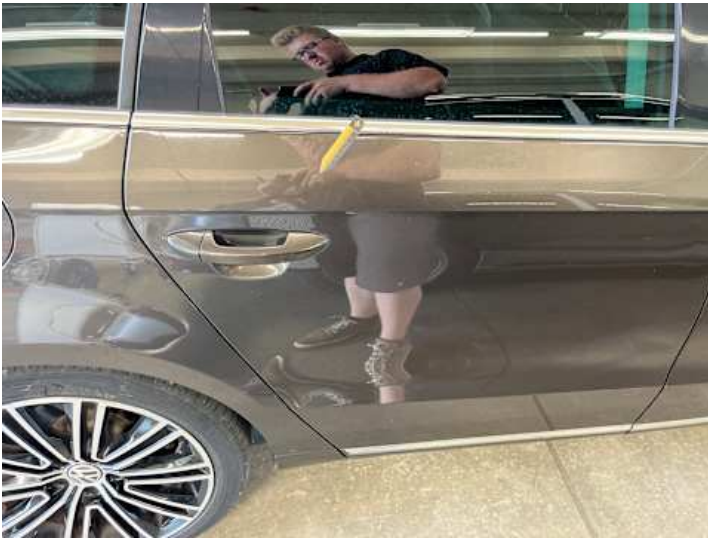
Türe hinten rechts (Lackschaden, Delle)
