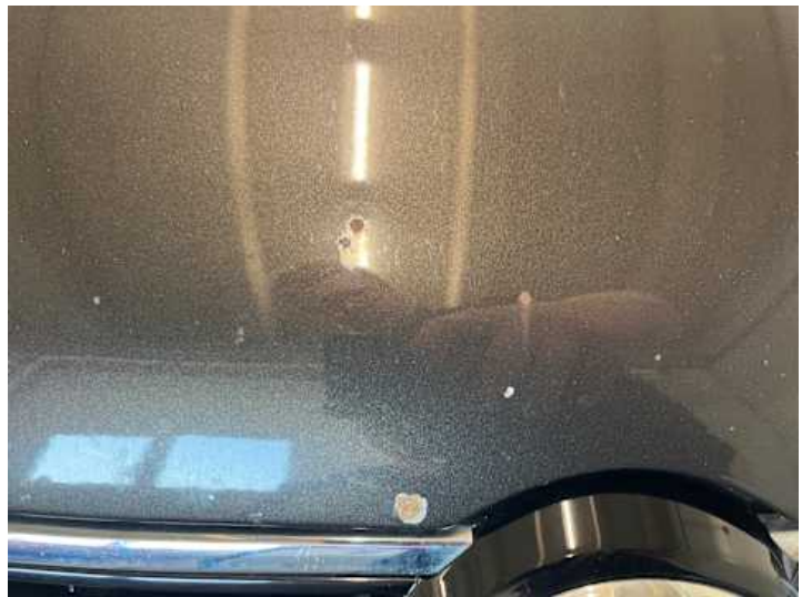
Motorhaube (Lackschaden, Rost, Steinschlag)
