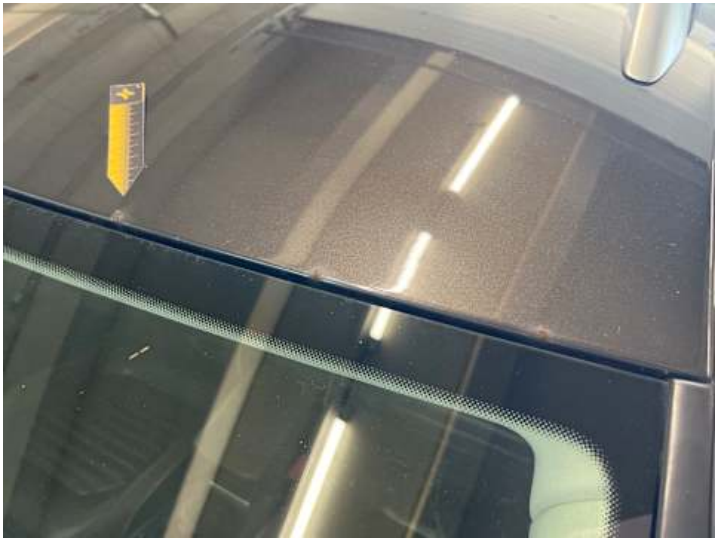
Dach (Lackschaden, Rost)
