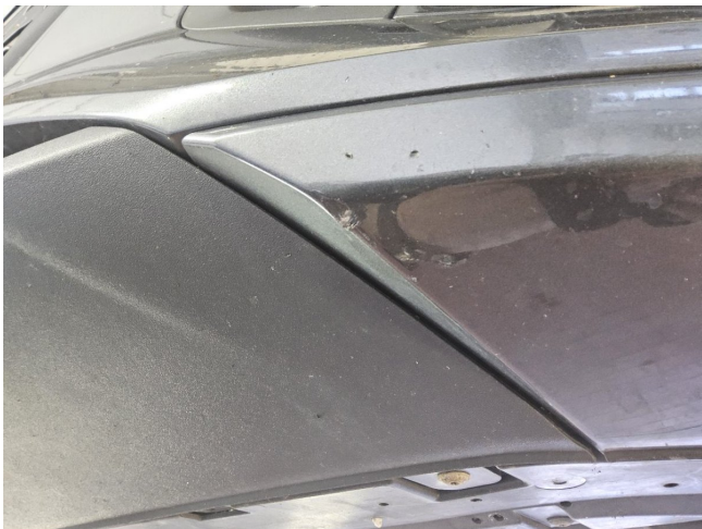
Stoßfängerverkleidung links verschrammt (DEKRA)
