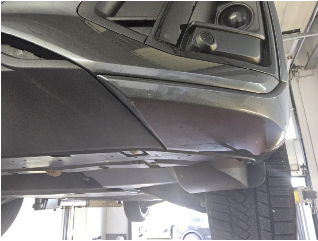
Stoßfängerverkleidung links verschrammt (DEKRA)
