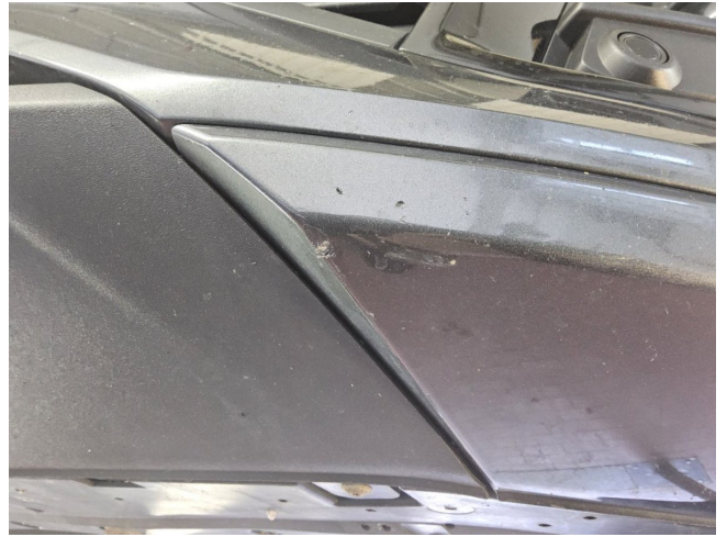
Stoßfängerverkleidung links verschrammt (DEKRA)
