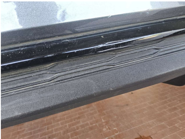
Stoßfängerverkleidung hinten bleibend plastisch verformt (DEKRA)
